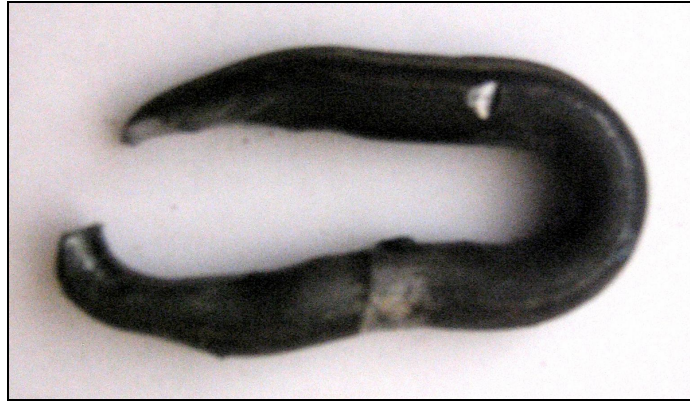
Şekil 5.14 Çekme deneyi sonucu kopan zincir.
