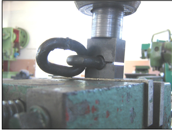
Şekil 5.11 Kalıpta preslenen zincir baklası.
