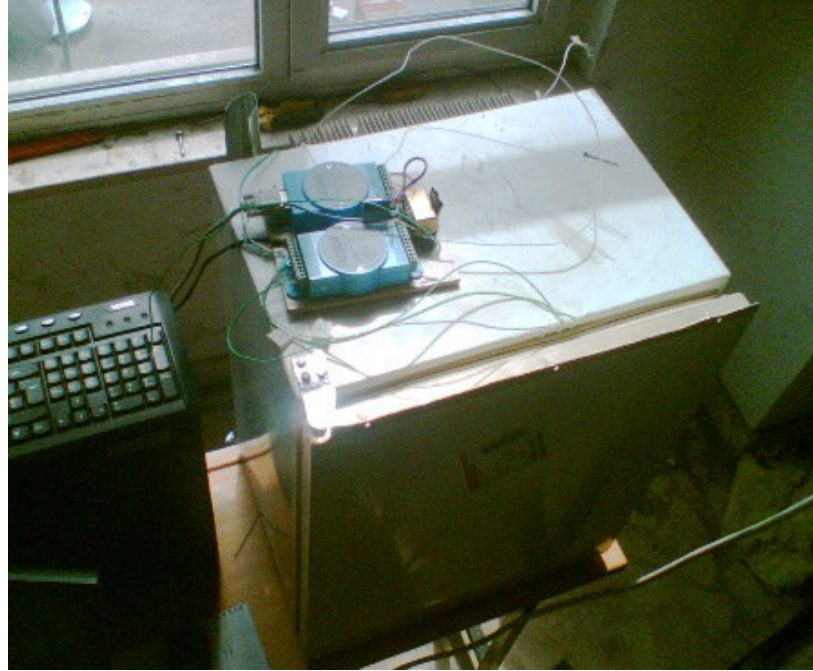
Şekil 4.6. Sisteme termokupulların bağlanması.
