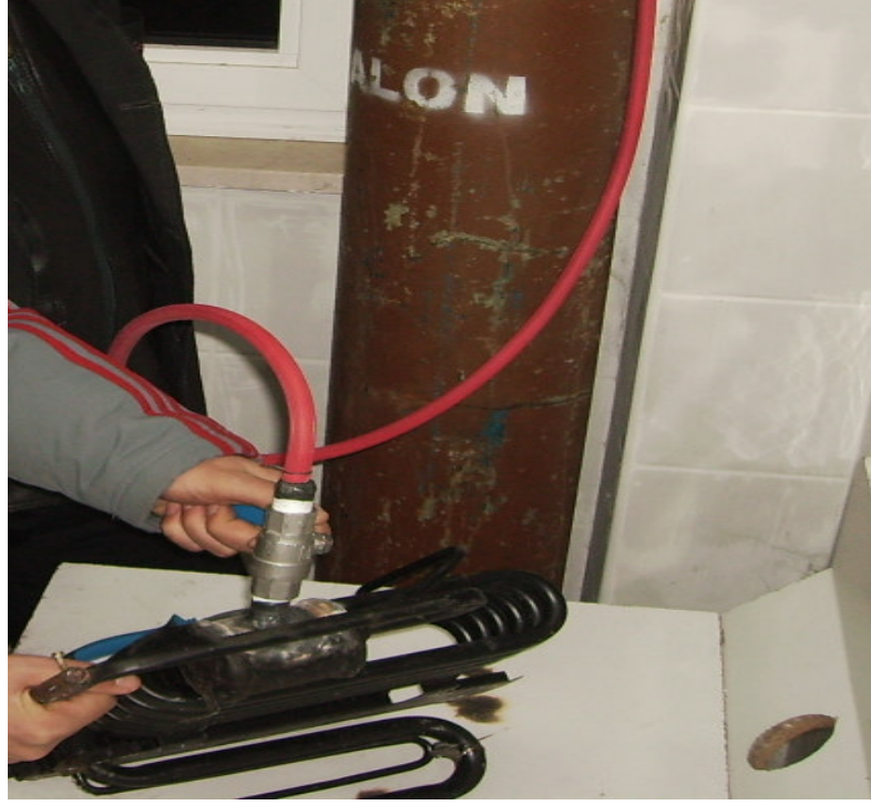
Şekil 4.5. Sisteme helyum gazı basılması.
