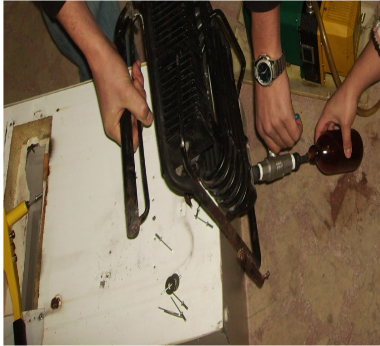
Şekil 4.4. Sisteme amonyak çözültisinin eklenmesi.
