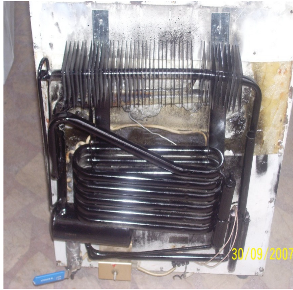
Şekil 4.2. Sistemin kabine montajı.
