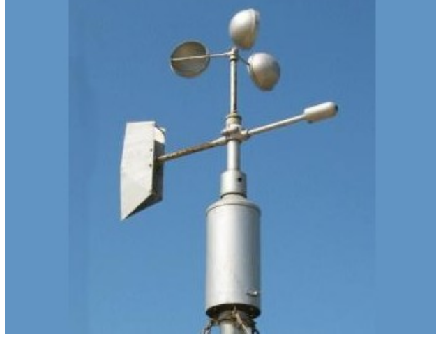
Şekil 4.12. Yaygın olarak kullanılan tipik analog rüzgâr ölçer (anemometre).
