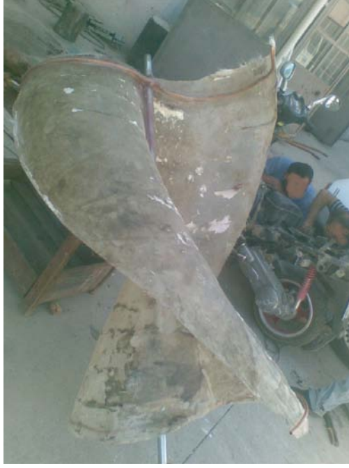
Şekil 4.8. Yatay eksenli savonius türbini kanat imalat aşamasından bir görüntü.
