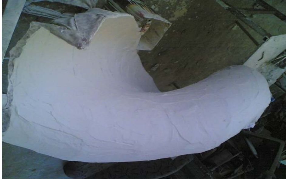
Şekil 4.6. Yatay eksenli savonius türbini kanat imalat aşamasından bir görüntü .
