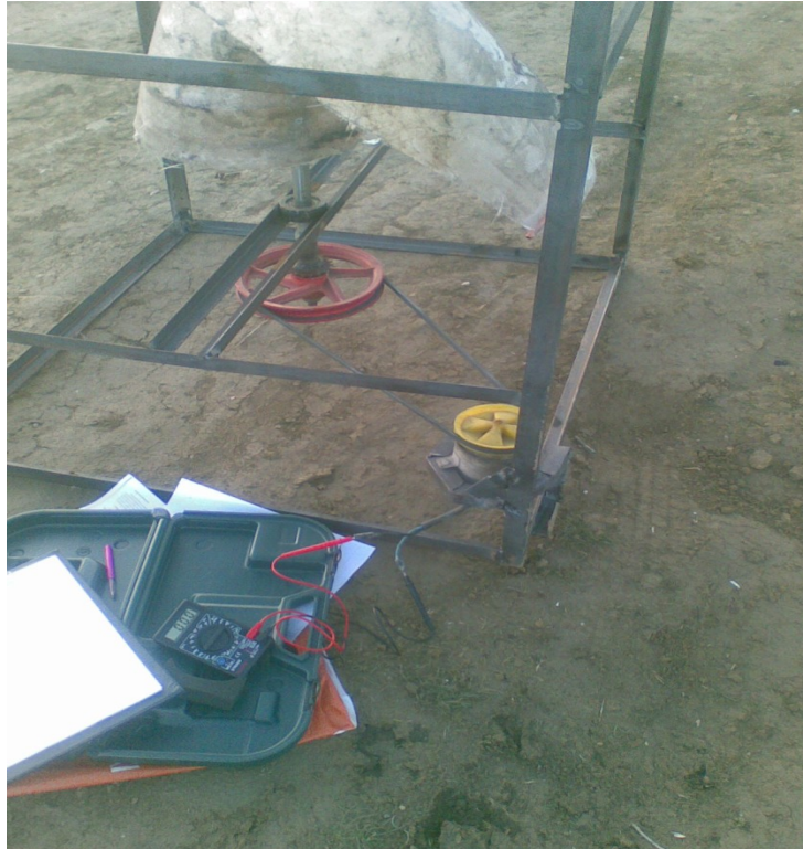
Şekil 4.10. Yatay eksenli savonius türbini deney aşamasından bir görüntü.
