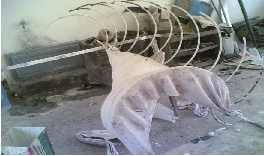
Şekil 4.4. Yatay eksenli savonius türbini kanat imalat aşamasından bir görüntü.
