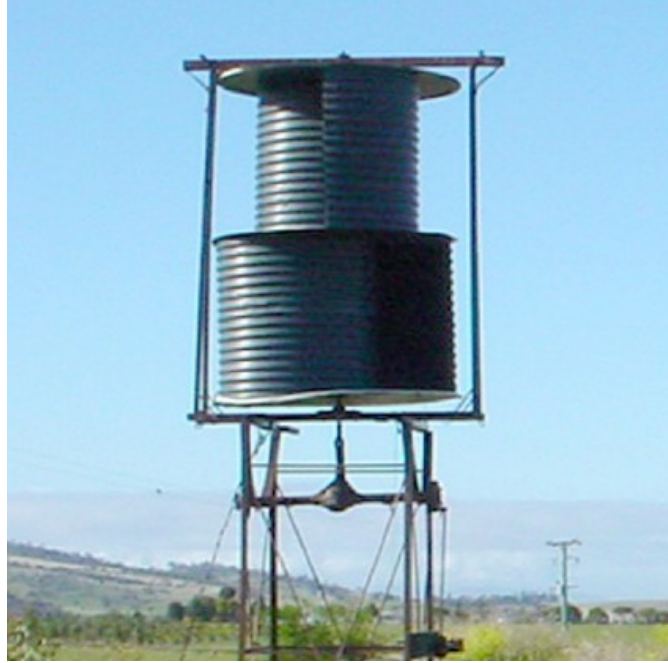
Şekil 3.6. İki katlı savonius türbini.
