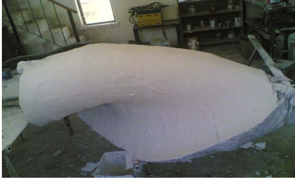
Şekil 4.5. Yatay eksenli savonius türbini kanat imalat aşamasından bir görüntü.
