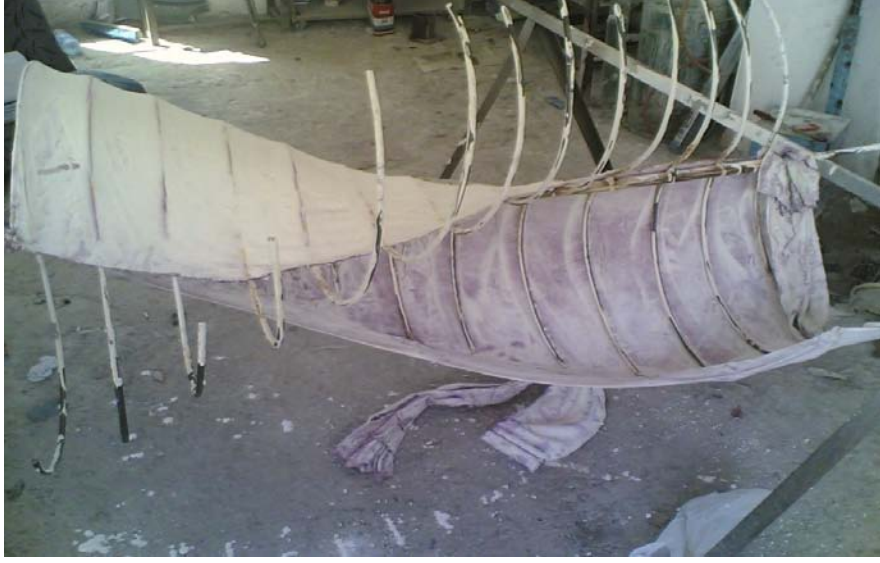
Şekil 4.3. Yatay eksenli savonius türbini kanat imalat aşamasından bir görüntü.
