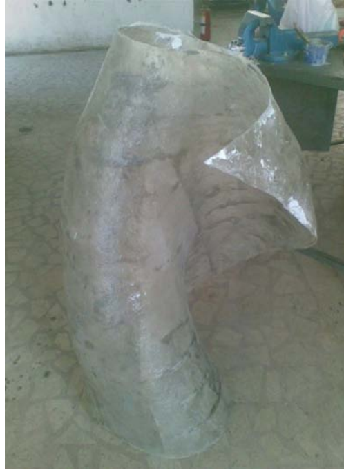
Şekil 4.7. Yatay eksenli savonius türbini kanat imalat aşamasından bir görüntü.
