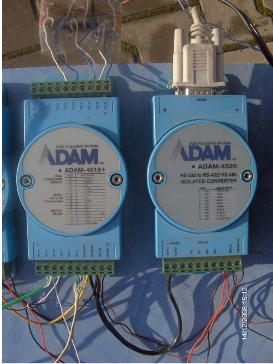
Şekil 5.11 Bilgisayar bağlantılı ölçümleri için kullanılan modüller.
