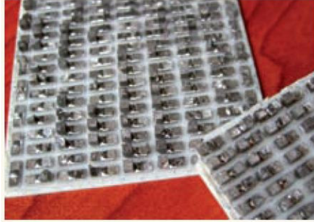
Şekil 4.2 TE modülün iç görünümü.
