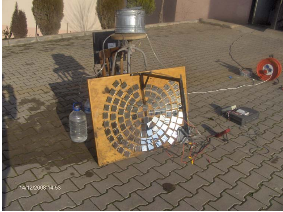
Şekil 5.9 Deney için kurulan düzenekte soğutma suyunun debisinin ölçülmesi.
