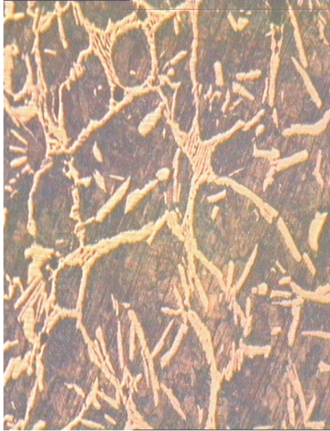
b. % 15 PP ile indirgenmiş numunenin yapısı
