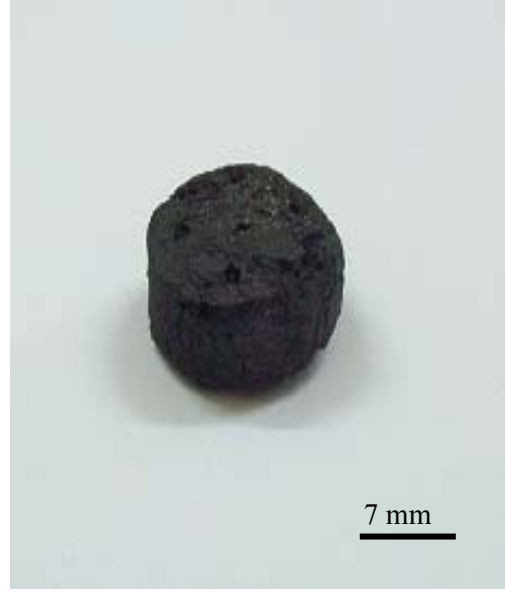
a. % 10 PE içeren indirgenme öncesi ve indirgenme sonrası görünümleri.
