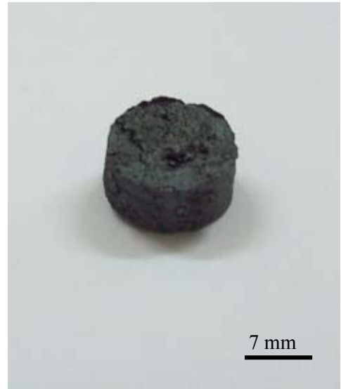
b. % 10 PP içeren indirgenme öncesi ve indirgenme sonrası görünümleri.
