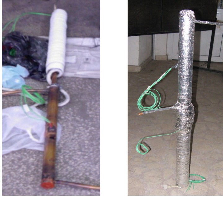
Şekil 3.2. Isı borusu yalıtımlarının yapımı
