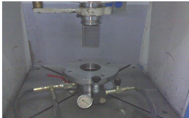
Şekil 4.2. Hidrolik şekillendirme sistemi.
