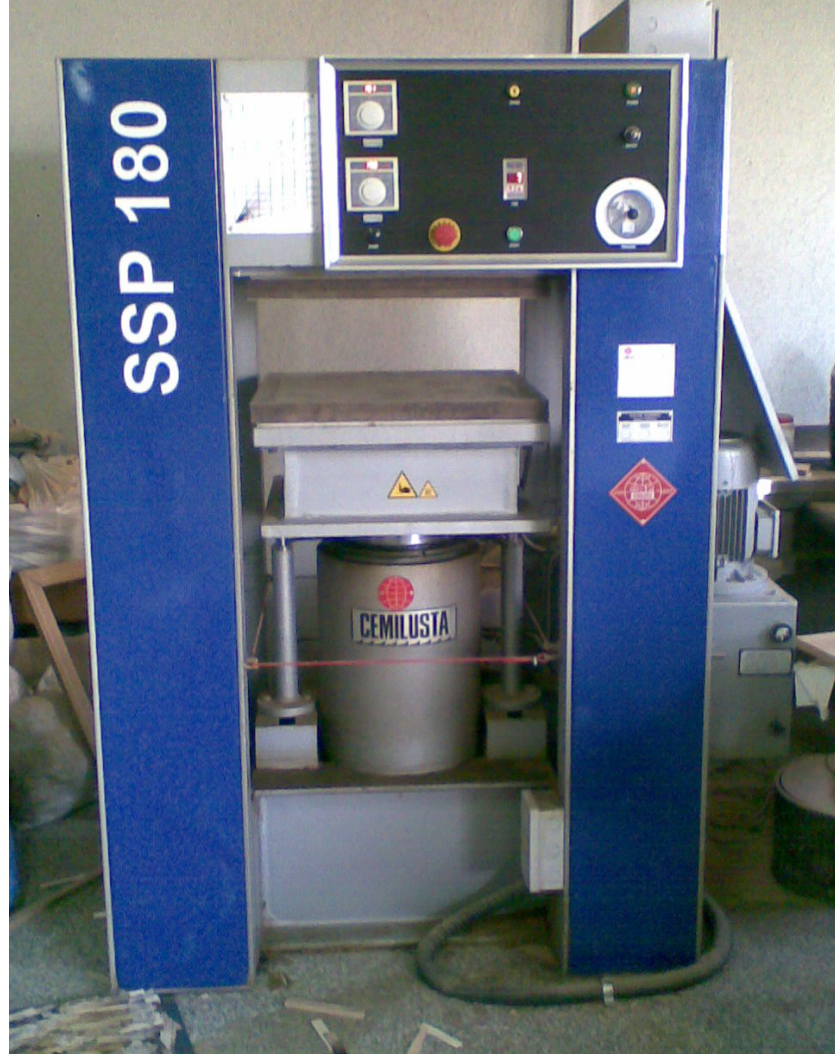
Şekil 2.8. 180 ton kapasiteli, tek katlı hidrolik pres.
