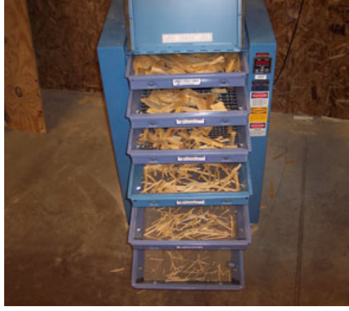
Şekil 1.37. Yongaların narınlık derecelerine göre sınıflandırılması.
