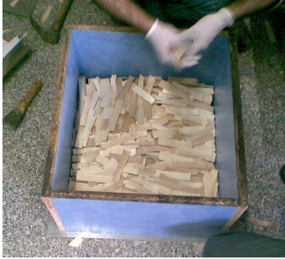
Şekil 2.6. Deney örneğinin taslak kalıp üzerinde orta katmanının serilmesi.
