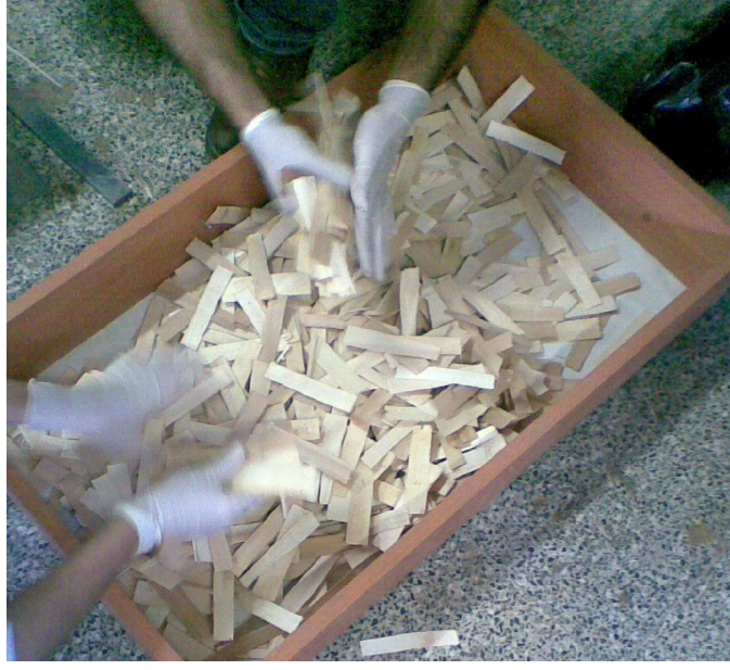
Şekil 2.4. Tutkallanan yongalardan taslak oluşturma.
