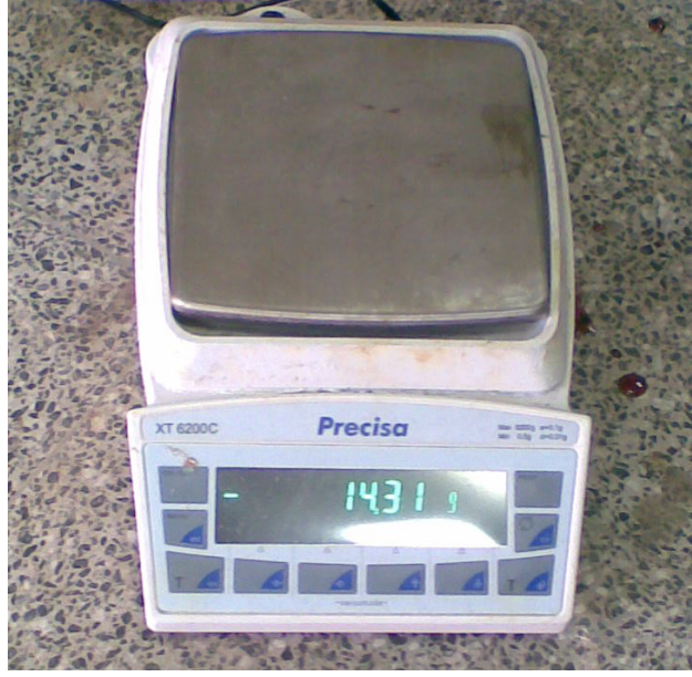
Şekil 2.9. Örneklerin tartıldığı \pm 0,01 g duyarlılıktaki dijital terazi.
