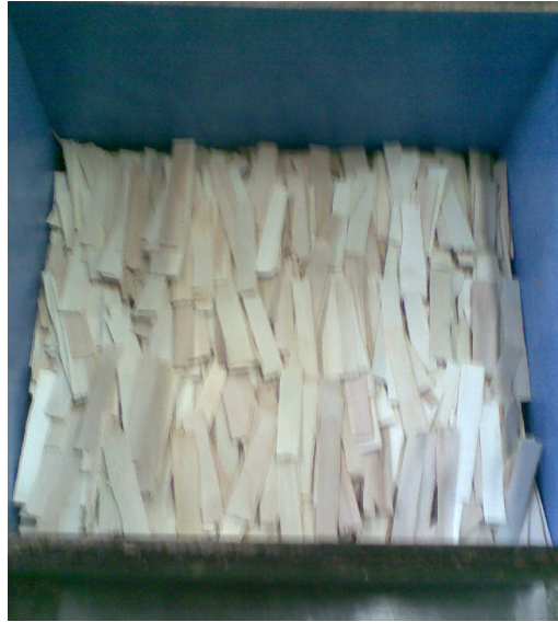
Şekil 2.5. Taslak oluşturmada 1. katmanın serilmesi.
