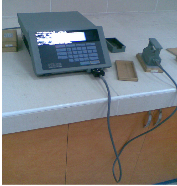
Şekil 2.10. QTM-500 Sıcak tel metodu ile çalışan ısı iletim katsayı cihazı.
