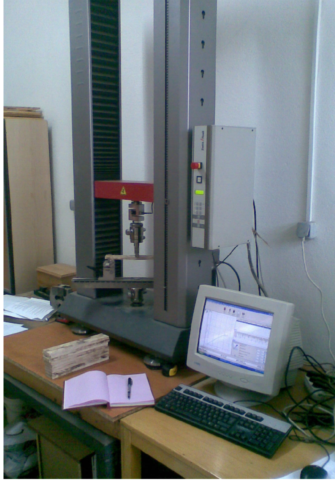
Şekil 2.12. 5000kg kapasiteli Zwick/Roell Z050 marka üniversal test makinesi
