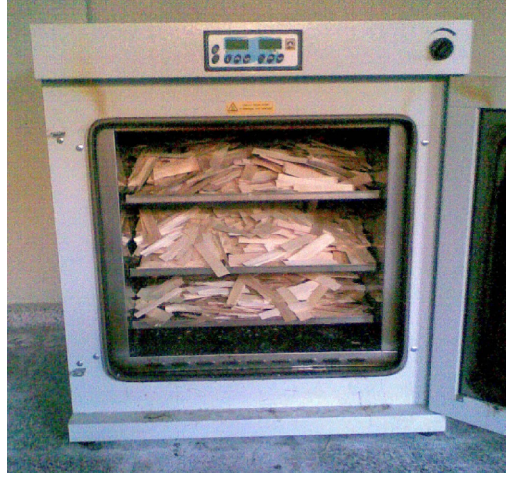
Şekil 2.3. Yongaların laboratuvar tipi etüvlerde kurutulması.
