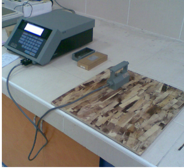
Şekil 2.11. Isı iletim katsayı cihazı ile levhanın farklı yerlerinde ölçüm yapılması.
