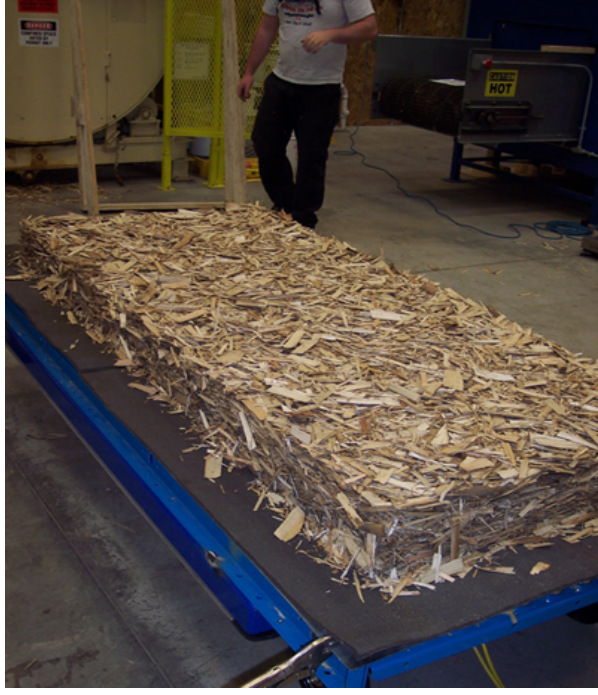
Şekil 1.18. Otomatik serme yöntemi ile yongalara form verilmesi.
