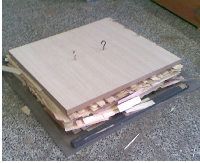
Şekil 2.7. Sıkıştırma tablası yardımı ile ön preslemenin yapılması.
