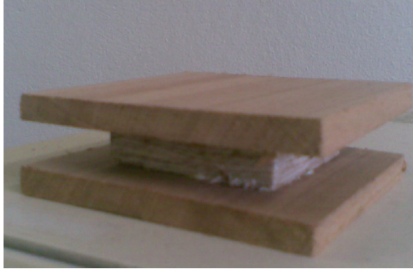
Şekil 2.14. Yüzeye dik çekme deneyi için hazırlanmış deney örneği.
