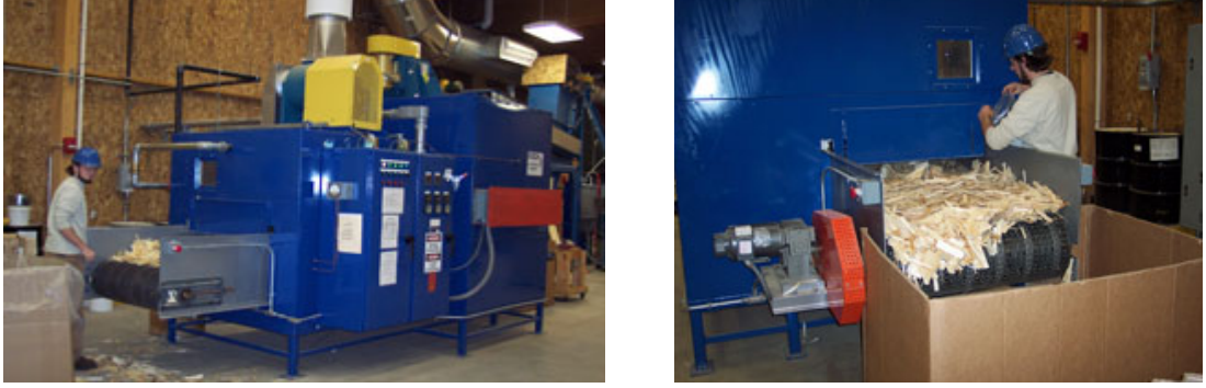
Şekil 1.14. Yongaların tam otomatik kurutma makinesinde kurutulması ve dışarı atılması.
