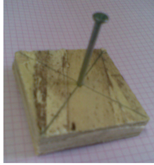
Şekil 2.17. Levha yüzeyine dik çivi tutma deneyi için hazırlanan örneklerin orta noktasının bulunması.
