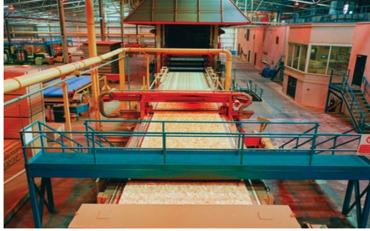
Şekil 1.22. Continue (sonsuz) preslerin çalışma şekli.
