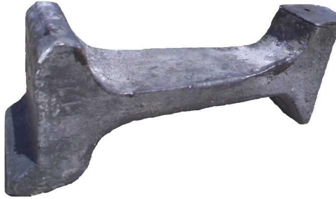
Şekil 4.26. Dökülmüş tren tekerleği dilimi (Tam tren tekerleğinin 1/16'lık kısmı).
