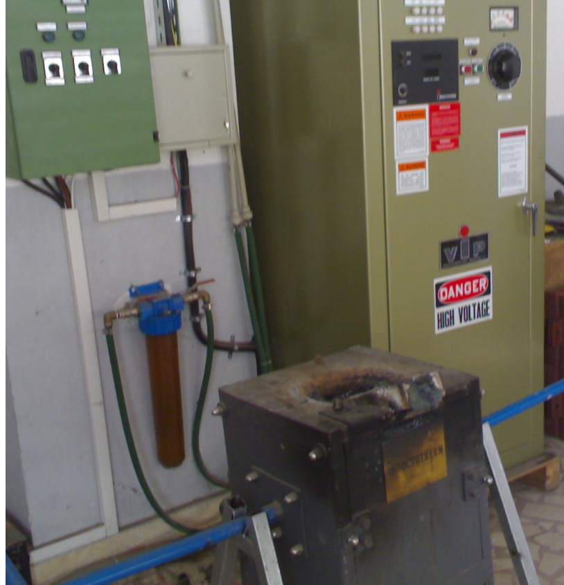
řekil 3.5. Döküm iřleminde kullanılan indüksiyon ocađı.
