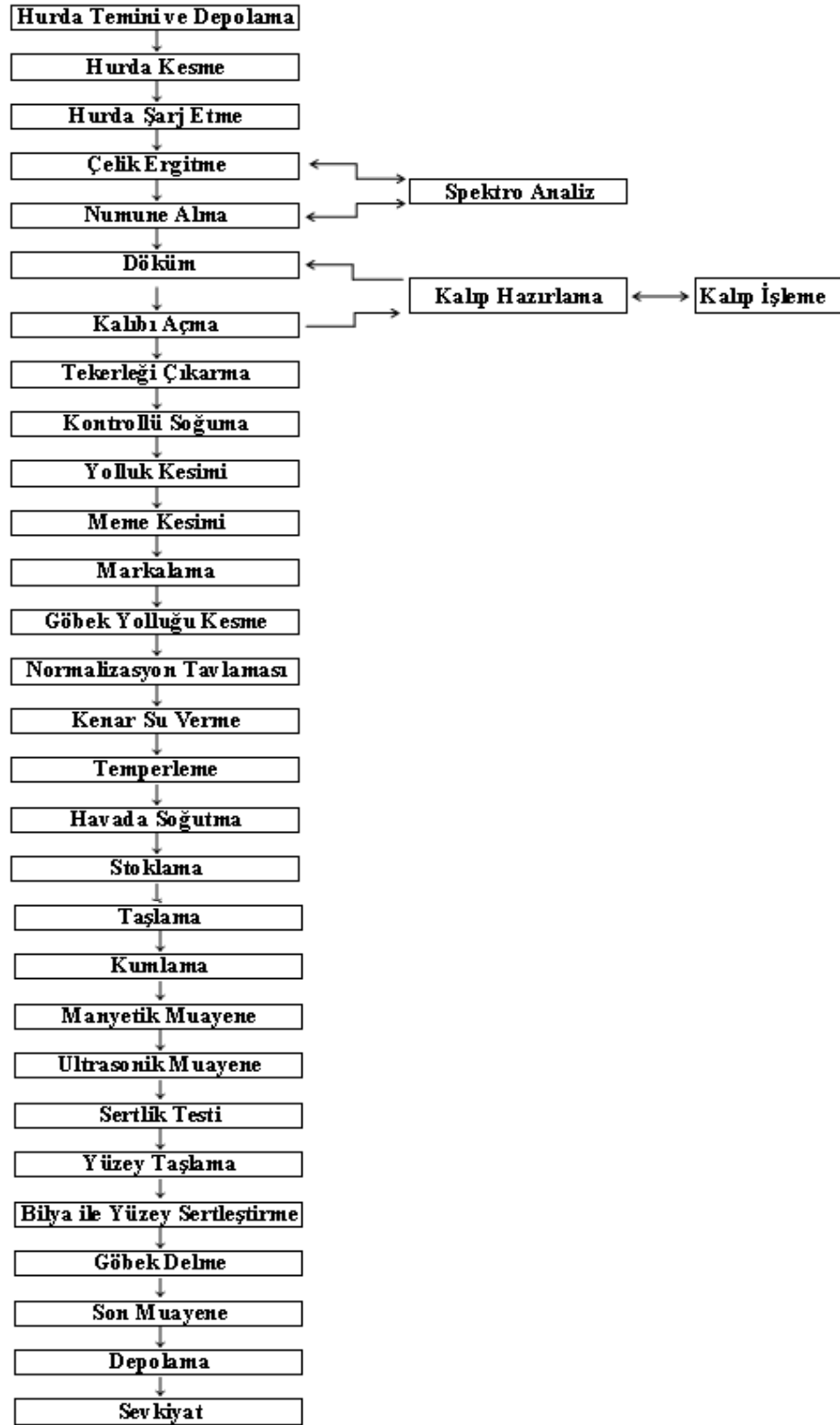
Şekil 2.5. Tren tekerleği üreten tipik bir döküm fabrikası akım şeması [10].
