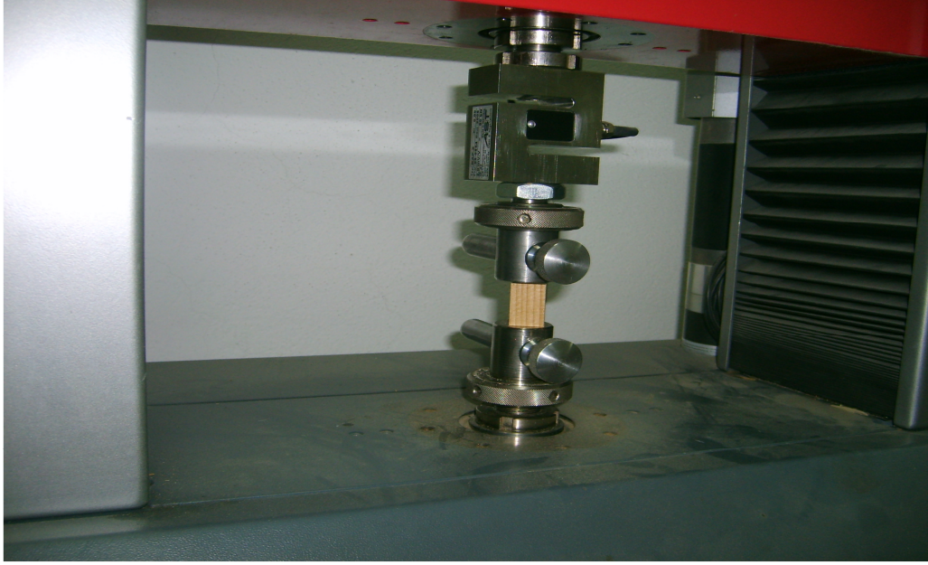
Şekil 2.3. Liflere paralel yönde basınç direnci deneyi.
