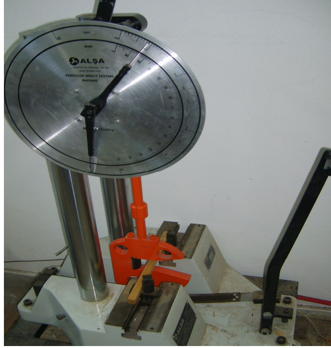
Şekil 2.4. Dinamik eğilme (şok) direnci deneyi.
