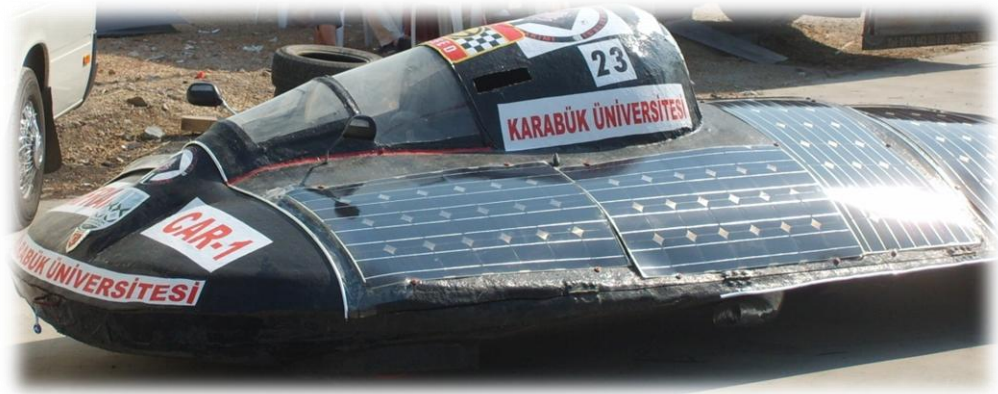
Şekil 3.20. Güneş Modülleri Montajı.
