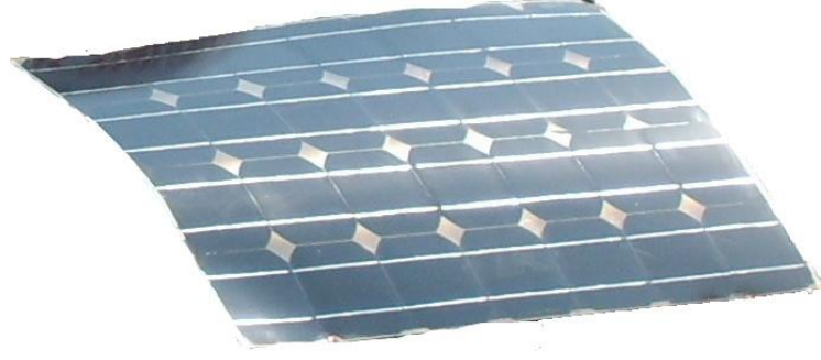
Şekil 3.17. Kapsülleme işlemi yapılmış yarı esnek güneş modülü.
