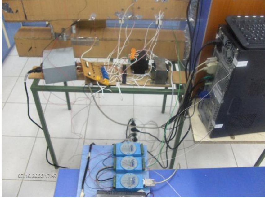
ekil A.7. ADAM 4019+ Modüllü Elektronik Kısım.
