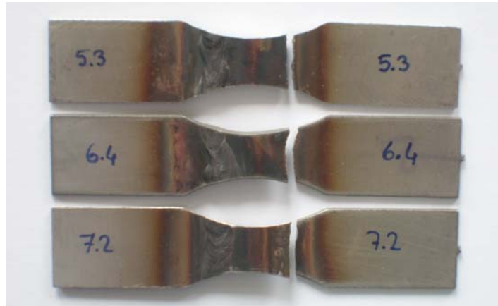
Şekil 6.19. Bindirme kaynaklı numunelerin yorulma kırılması sonrası görünüşleri
