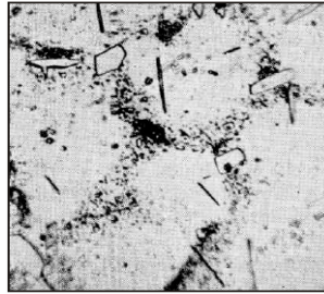
Şekil 2.12. 25Cr/20Ni (0,10C)'lu elektrod kullanılmıştır. 780 °C'da 100 saat ısıtım işlemi uygulanmış ve sigma fazı çizgileri oluşmaya başlamıştır (x1600).
