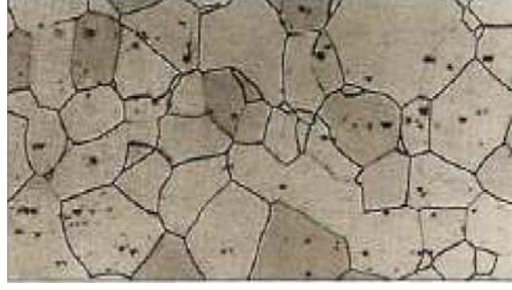
Şekil 2.2. Ferritik paslanmaz çeliğin mikroyapısı [5].
