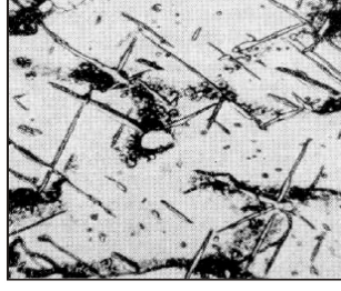
Şekil 2.13. 25 Cr/20 Ni (0,10C)'lu elektrod kullanılmış, 780 °C'da 500 saat ısıl işlem uygulanmış ve sigma fazı çizgileri artarak iyice belirgin hale gelmiştir (x1600) [7].
