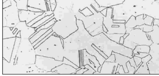
Şekil 2.5. Östenitik paslanmaz çeliğin mikroyapısı [5].
