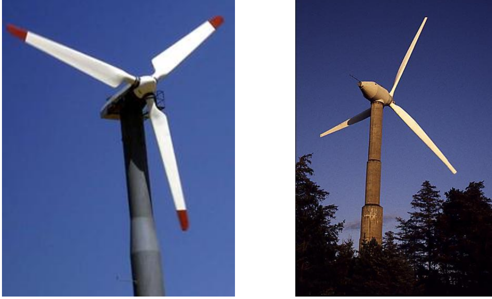
Şekil 2.7. Önden ve arkadan rüzgar alan yatay eksenli rüzgar türbinleri.
