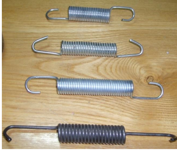
Şekil 3.9. KKM’da deneye tabi tutulan çekme yayları.
