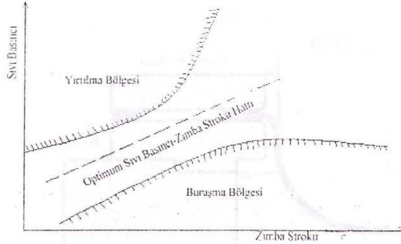
Şekil 1.2. Bükme işleminde zımba stroęu-optimum sıvı basıncı iliřkisi.
