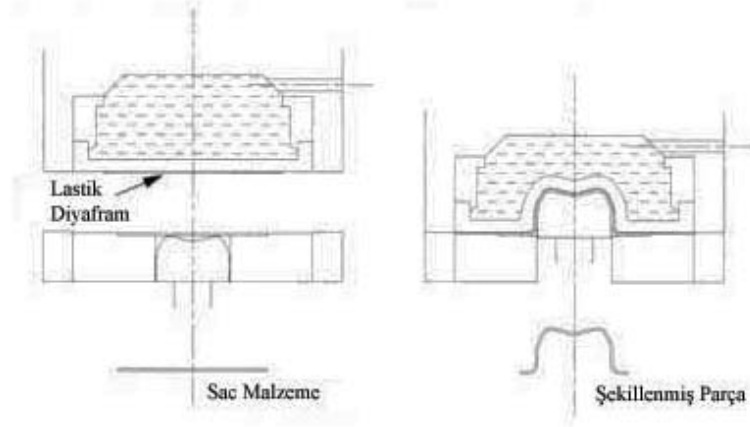
Şekil 2.10. Diyafram destekli hidro şekillendirme.
