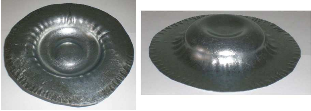
Şekil 5.7. Kestamit zımba ucuyla şekillendirilmiş 0,35 mm kalınlıktaki çelik sac malzeme.
