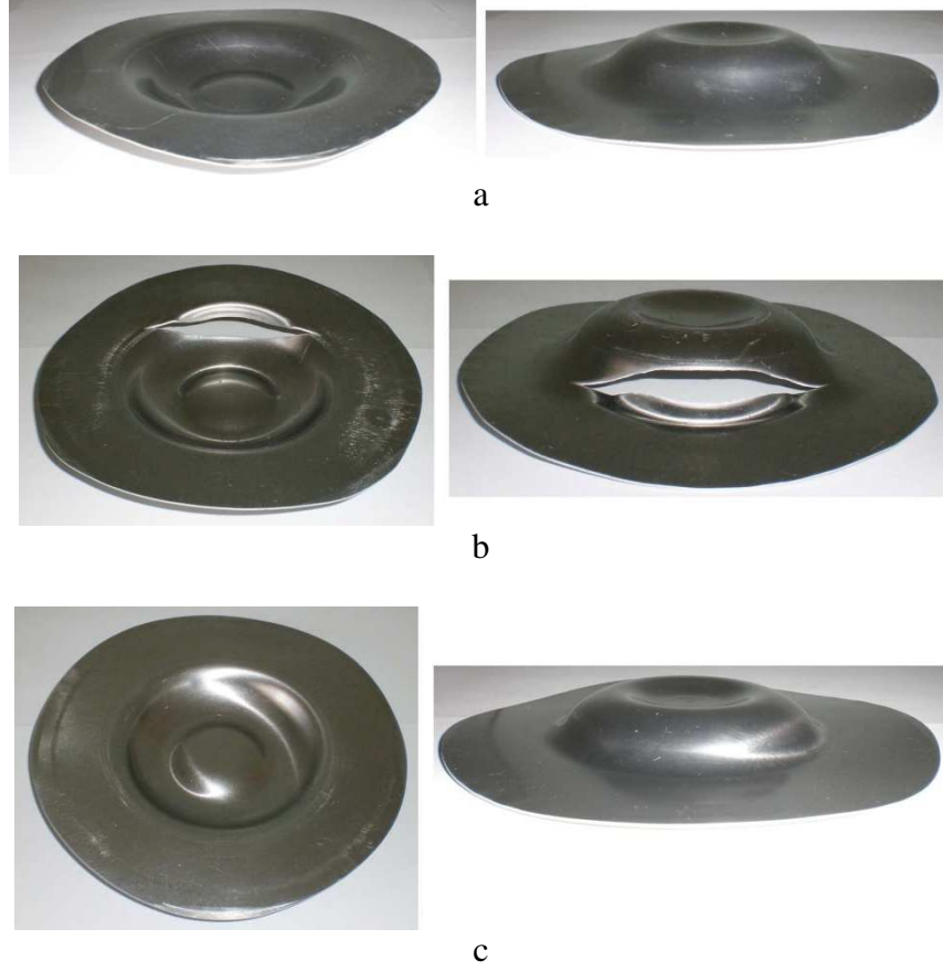
Şekil 5.4. Kestamit zımba ucuyla şekillendirilmiş alüminyum malzemeler. a. 7 MPa akışkan basınçlı, b. 10 MPa akışkan basınçlı, c. 15 MPa akışkan basınçlı.
