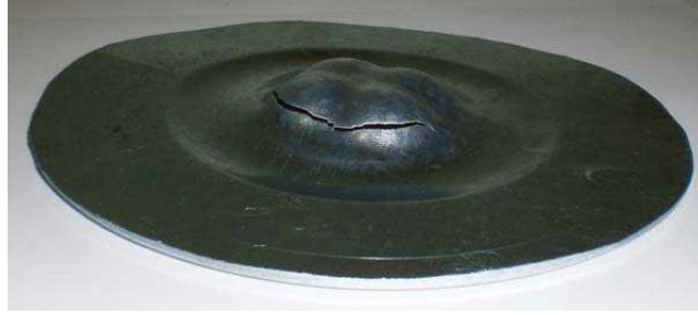
Şekil 5.13. Desenli zımba ucuyla 4 MPa akışkan basıncında şekillendirilmiş 0,35 mm kalınlığındaki çelik sac malzeme.
