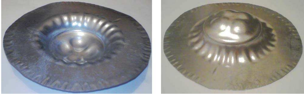
Şekil 5.14. Desenli zımba ucuyla 7 MPa akışkan basıncında şekillendirilmiş 0,35 mm kalınlığındaki çelik sac malzeme.
