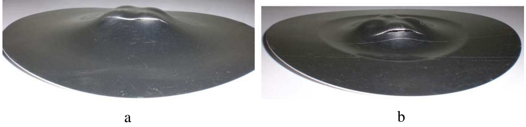
Şekil 5.10. Desenli zımba ucuyla şekillendirilmiş alüminyum malzemeler. a. Ön basınçsız 2 MPa akışkan basınçlı, b. Ön basınçlı 4,5 MPa akışkan basınçlı.
