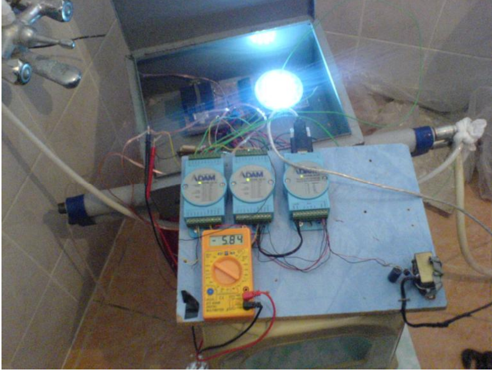
ekil 5.1. TE jeneratör ile LED’li aydınlatma sisteminin çalıştırılması deneyi
