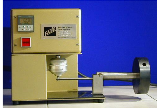
Şekil 5.4. BOTD cihazının a) çalışma prensibi b) genel görünümü ( www.falexint.com ).
