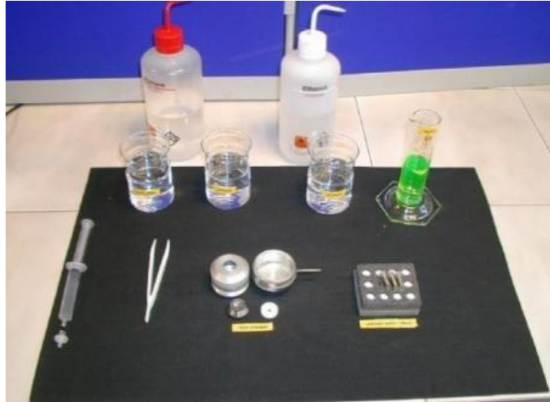
Şekil 5.5. BOTD testinde kullanılan malzemeler (Test yakıtı, Seramik top, Üç tane deney disk, Temizleyici sıvı (etanol, beyaz ispirto, aseton) ve diğer malzemeler) ( www.falexint.com ).
