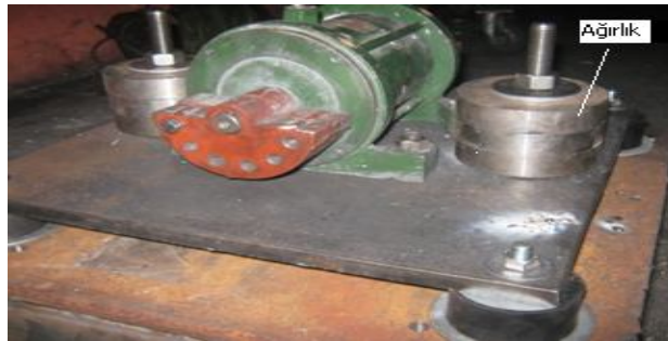
Şekil 5.6. Titreşim masasının üzerindeki ek ağırlıkların resmi
