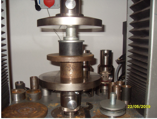
a) Numunelerin ezilme testi
