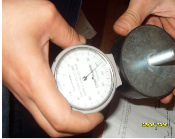
Şekil 5.8. Sertlik ölçüm cihazı
