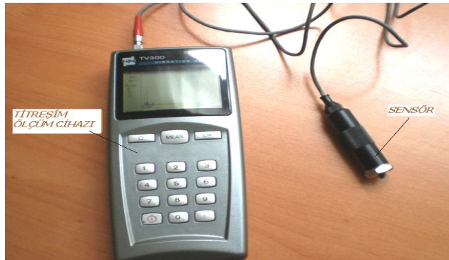
Şekil 5.4. TIME TV300 vibrasyon ölçüm cihazı ve sensörü
