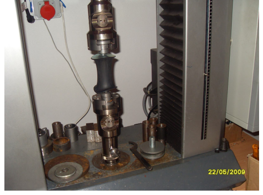
b) Numunelerin uzama testi
