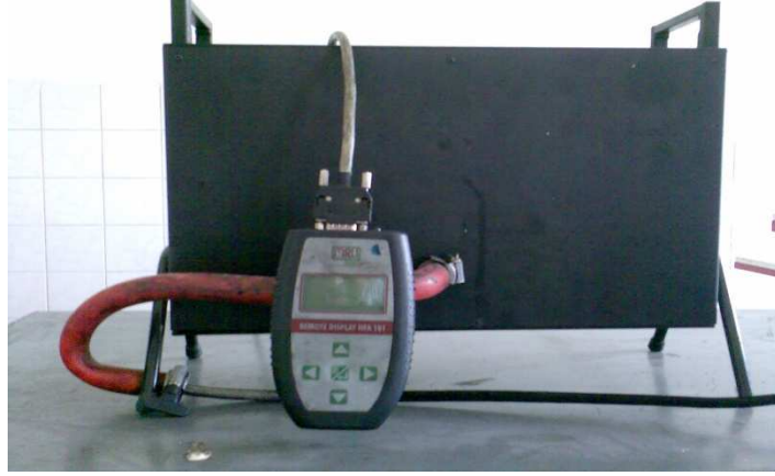
Şekil 5.7. Duman yoğunluğu ölçüm cihazı
