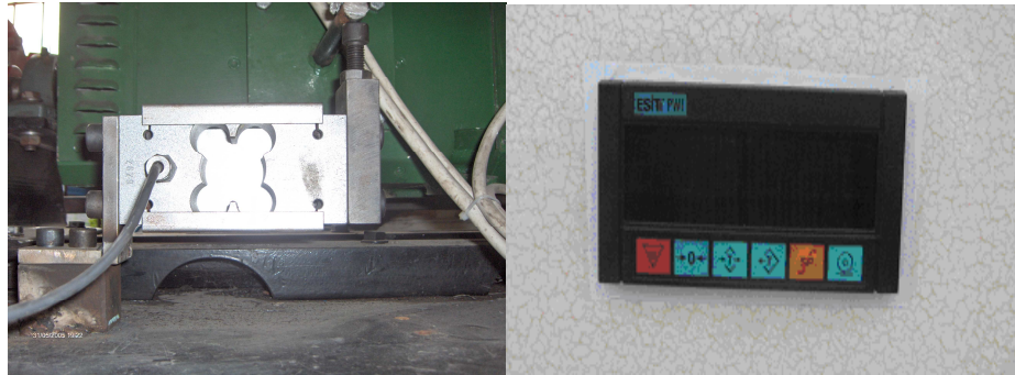
Şekil 5.8. Load cell ve indikatörün görünümü
