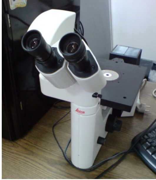
Şekil 5.3. Miroyapı incelemelerinde kullanılan Leica DM ILM model optik ışık mikroskobu.
