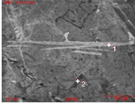
Şekil 6.9. EDS analizi yapılmış Al-12Si-20Mg-4Pb alaşımına ait SEM görünümü.
