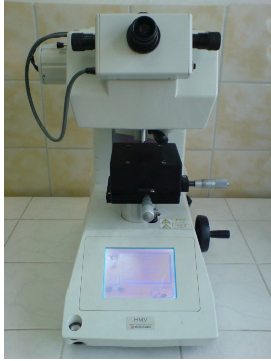
Şekil 5.4. Sertlik ölçümlerinde kullanılan Shimadzu HMV2 mikrosertlik test cihazı.
