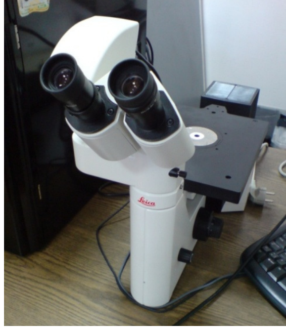
Şekil 5.3. Mikroyapı incelemelerinde kullanılan Leica DM ILM model optik ışık mikroskobu.
