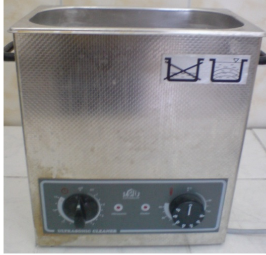
Şekil 5.5. Numune temizleme işlemlerinde kullanılan MBTU marka ultrasonik temizleme cihazı.
