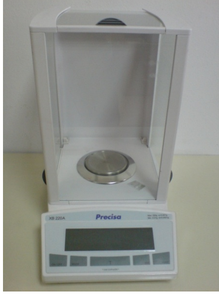
Şekil 5.6. Ağırlık kayıplarının belirlenmesinde kullanılan Precisa marka XS 220A model 0,1 mg hassasiyete sahip elektronik tartı.
