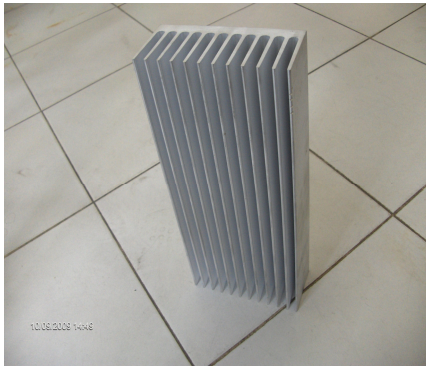
Şekil 6.4. Kanatlı alüminyum plaka (model AS80) ve ölçüsü [39].
