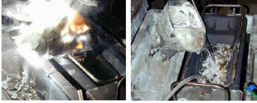
Şekil 2.29. Mg alaşımı dökümlerinde gaz kullanımı a) Atmosfer ortamı b) SF 6 (Hillis 2002).
