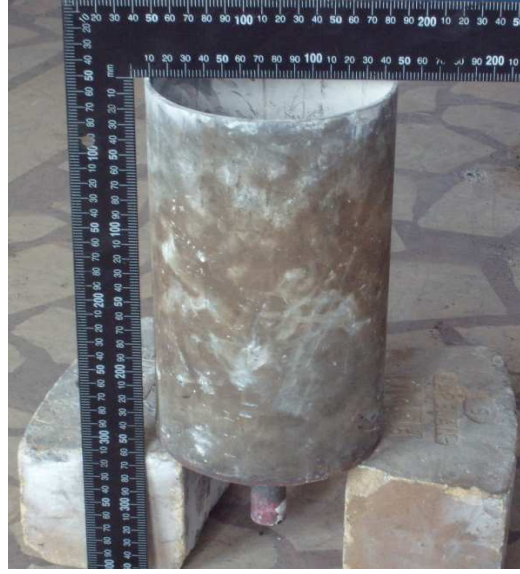
Şekil 3.3. Ergitme işleminde kullanılan paslanmaz çelik pota fotoğrafı.
