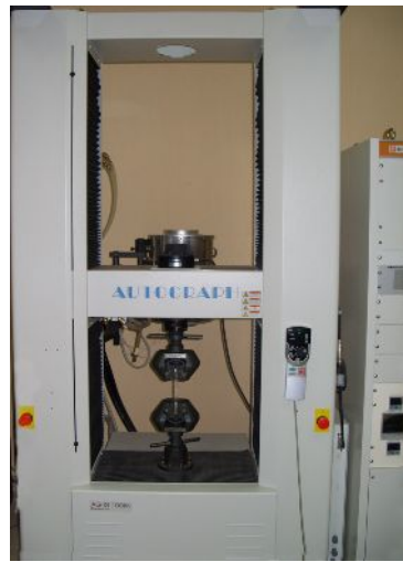
Şekil 4.7. Çekme test cihazında testin uygulanışı.
