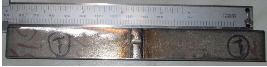
Şekil 4.8. Üç nokta eğme test numunesi.
