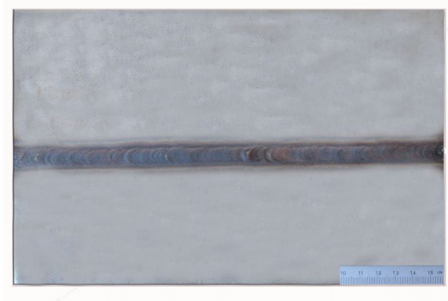
Őekil 4.3. ER 347 kaynak ilave metali ve AR + %4 N koruyucu gazı ile TIG ark kaynak yntemiyle birleřtirilen deney numunesi grnř.
