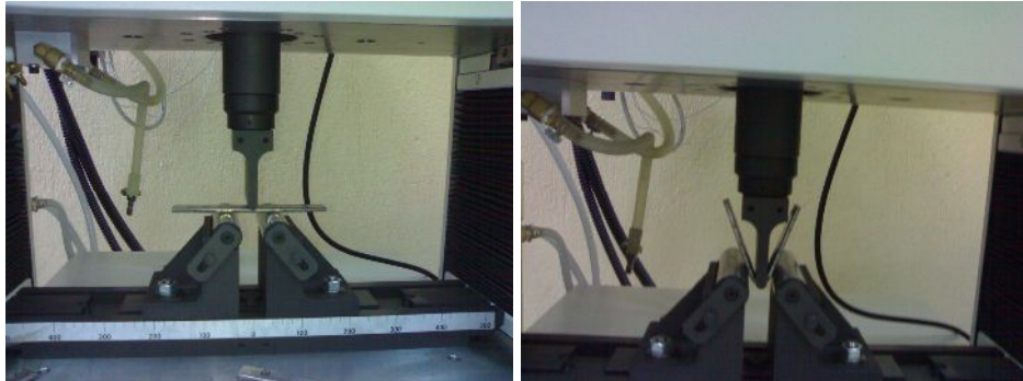
Şekil 4.9. Üç nokta eğme deneyinin uygulanmasına ait görüntü.
