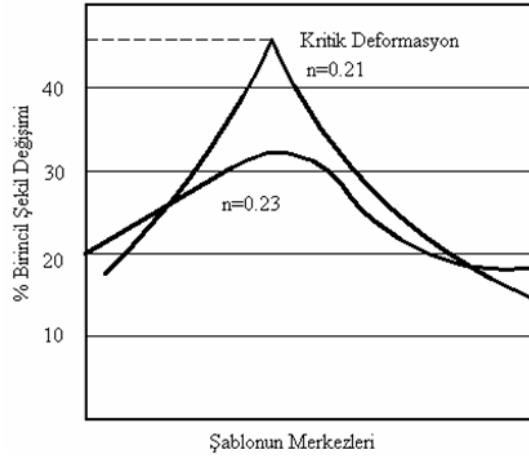
Şekil 2.9. n değerinin kritik deformasyon miktarına etkisi [43].
