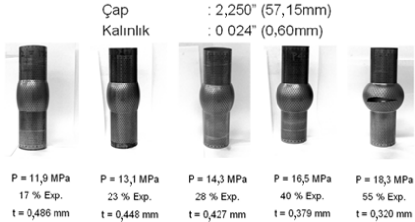
Şekil 1.3. Farklı basınç değerlerinde tüpün aldığı şekiller [12].
