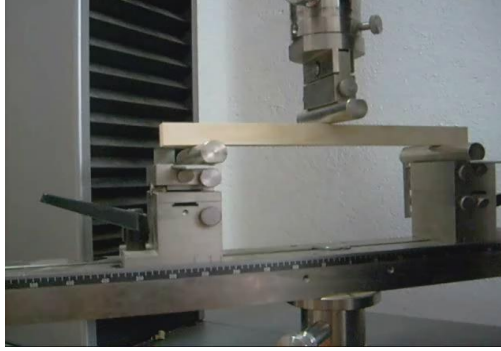
Şekil 2.7. Üniversal test cihazında eğilme direnci ve elastikiyet modülü deneyi
