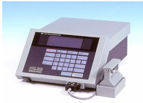
Şekil 2.4. QTM-500 cihazı ile ısı iletkenlik katsayısı deneyi
