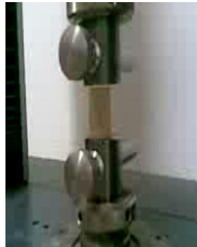
Şekil 2.6. Üniversal test makinesinde liflere paralel basınç direnci
