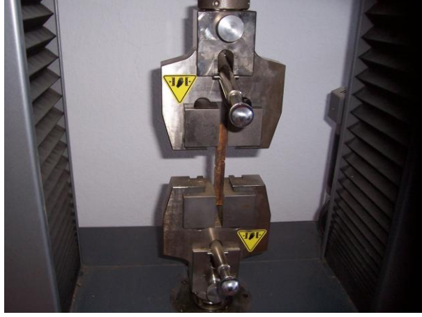
Şekil 2.2. Üniversal test makinesinde yapışma direnci.
