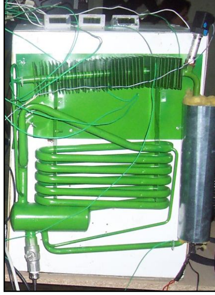
Şekil 4.1. YSS sisteminde elektrikli ısıtıcı kullanımı.
