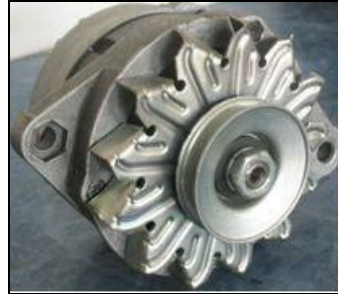
Şekil 5.4. Pençe tipi alternatör
