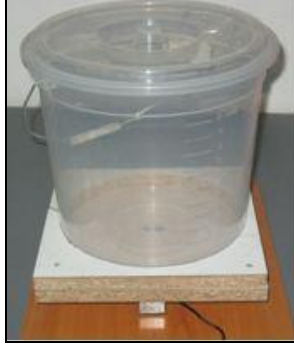
Şekil 5.7. Hassas yakıt kabı
