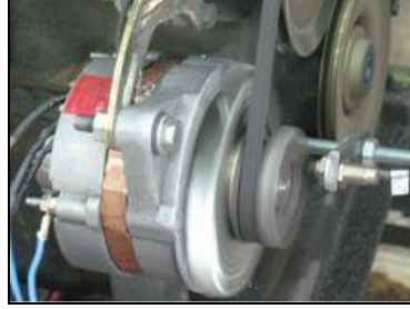
Şekil 6.1. İYM üzerine monte edilen alternatörün çalışması.
