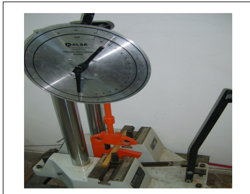
Şekil 3.3. Dinamik eğilme (şok direnci) deneyi
