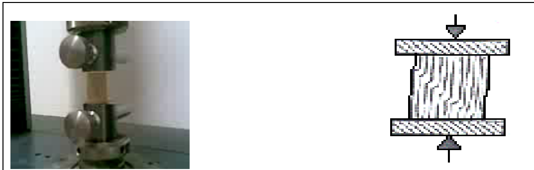
Şekil 3.2. Liflere paralel basınç direnci deneyi
