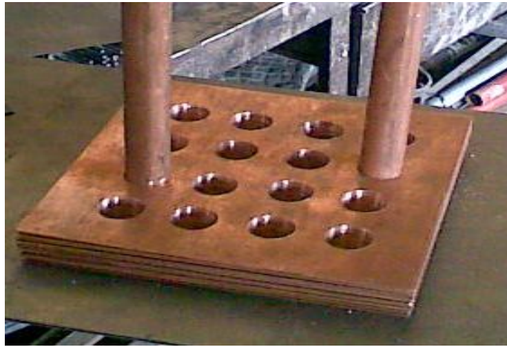
Şekil 3.2. Kanatçıkların ısı borularına yerleştirilmesi
