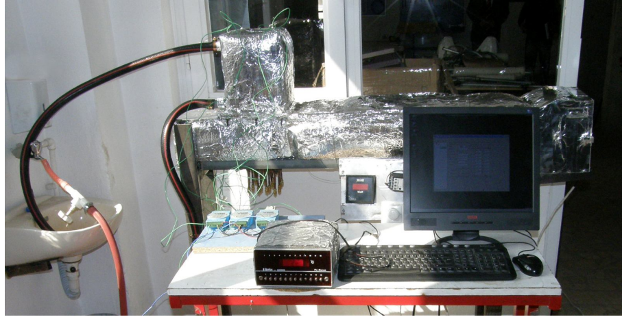
Şekil 3.15. Verilerin modüller yardımıyla bilgisayar ortamına aktarılması
