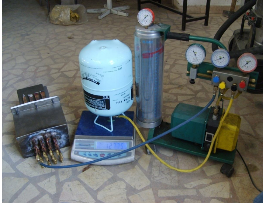
Şekil 3.4. Isı borularının vakumlanması ve akışkan doldurulması
