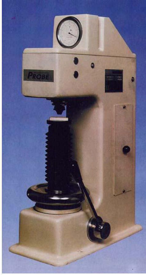
Şekil 2.6. Brinell-Mörath metoduna göre sertlik deneyi (Berkel, 1970).
