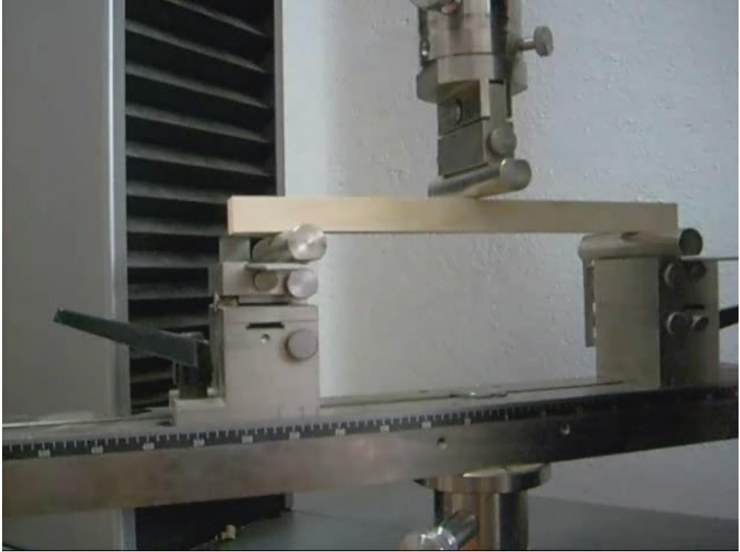
Şekil 2.4. Üniversal test cihazında eğilme direnci ve elastikiyet modülü deneyi
