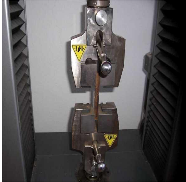
Şekil 3.1. Üniversal test makinesinde yapışma direnci(TS, 3639)
