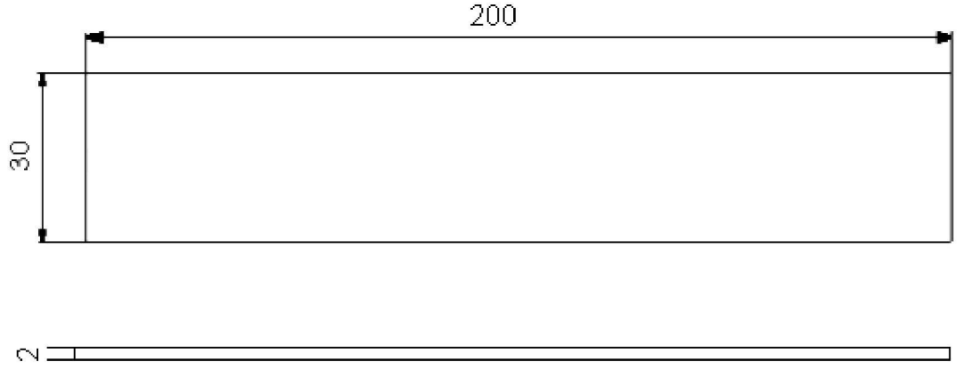
Şekil 5.1 Ana malzeme deney numune boyutları.
