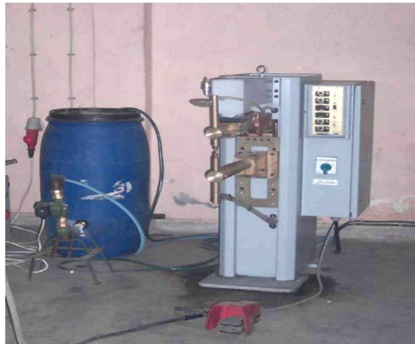
Şekil 5.3 Kullanılan SPP60 tipi nokta direnç kaynak makinesi ve donanımı.
