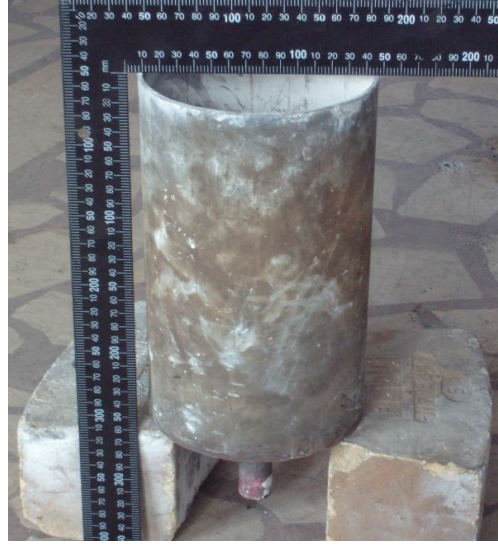
Şekil 3.2. Ergitme işleminde kullanılan paslanmaz çelik pota fotoğrafı.
