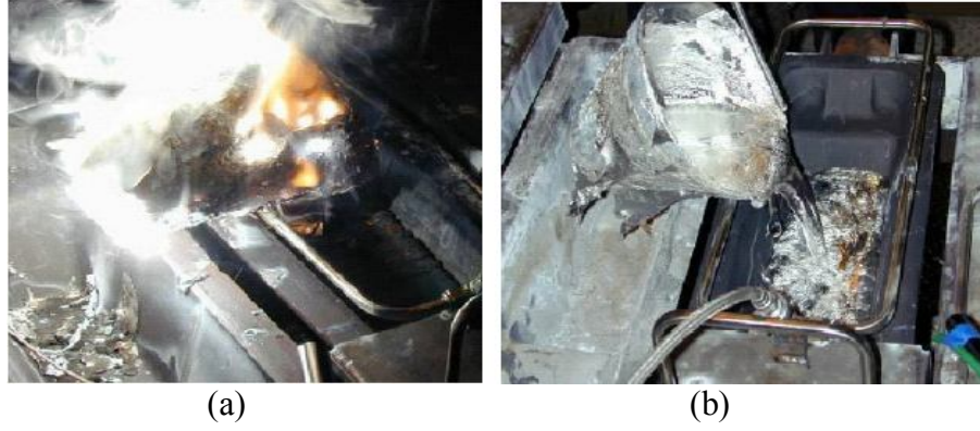
Şekil 2.29. Mg alaşımı dökümlerinde gaz kullanımı a) Atmosfer ortamı, b) SF 6 (Hillis 2002).
