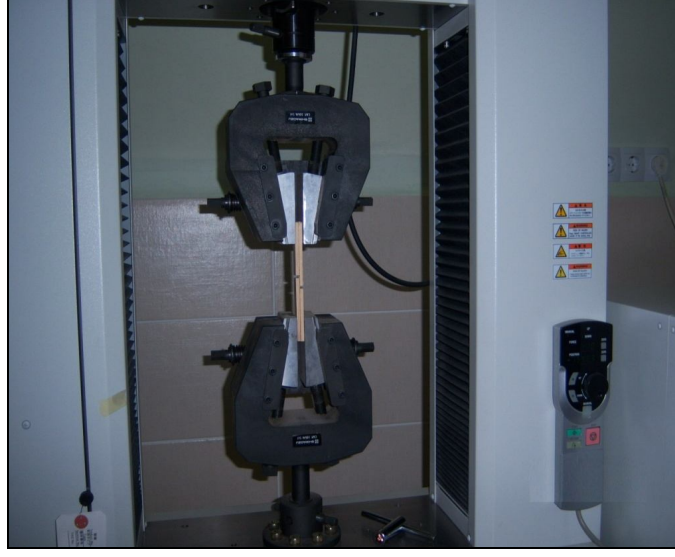
Şekil 3.3. Üniversal test cihazında yapışma direnci deneyi
