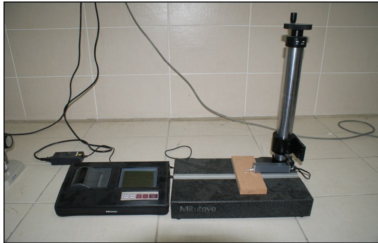
Şekil 3.1. Yüzey pürüzlülüğü ölçüm cihazı ( Mitutoyo SJ-301 ).
