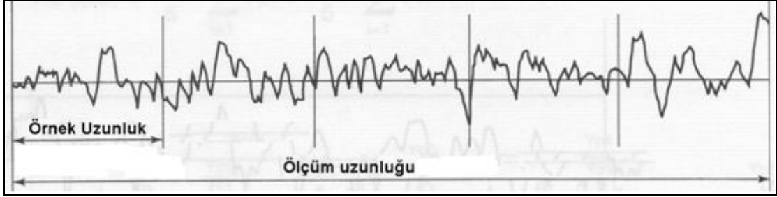
Şekil 2.2. Yüzey pürüzlülüğü ölçüm uzunluğu ve grafik çıktısı örneği
