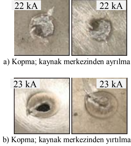
Şekil 6.6. Kaynaklı numunelerin kopma şekilleri.
