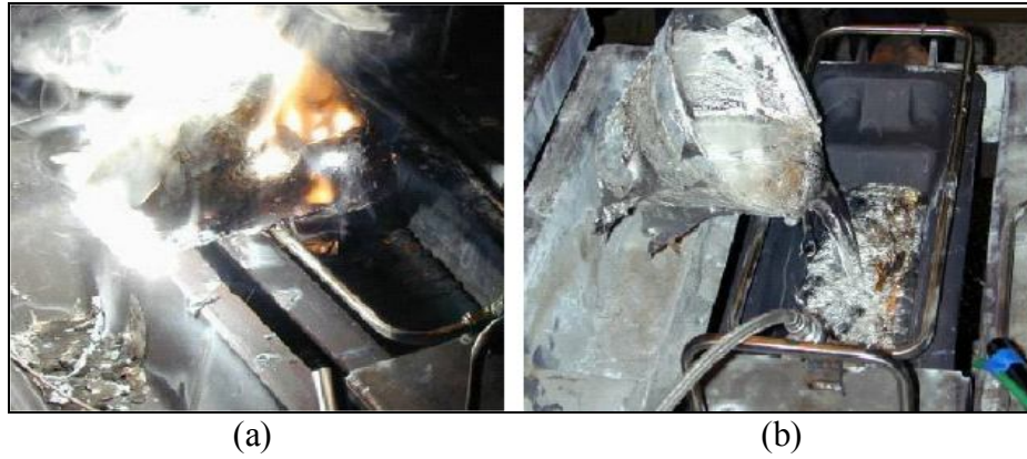
Şekil 3.5. Mg alaşımı dökümlerinde gaz kullanımı a) atmosfer ortamı b) SF 6 [45]
