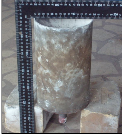
Şekil 4.2. Ergitme işleminde kullanılan grafit pota resmi.
