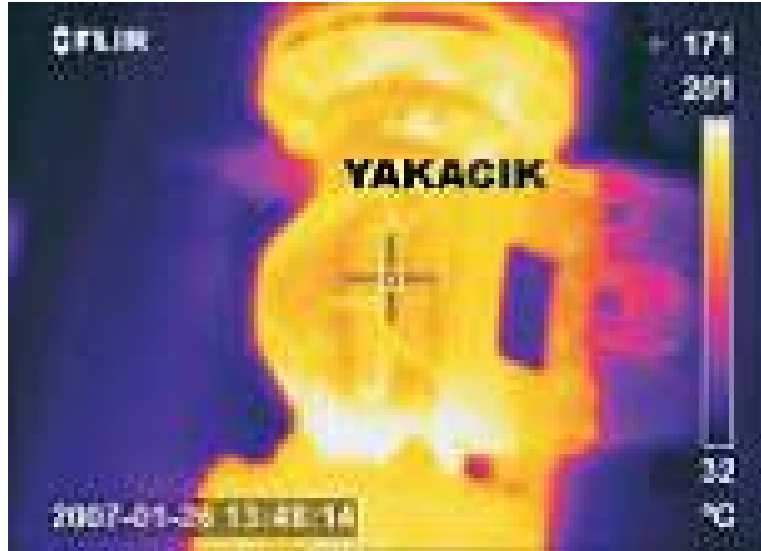
Şekil 4.4. Yalıtımsız vananın termal kamera görüntüsü [25].
