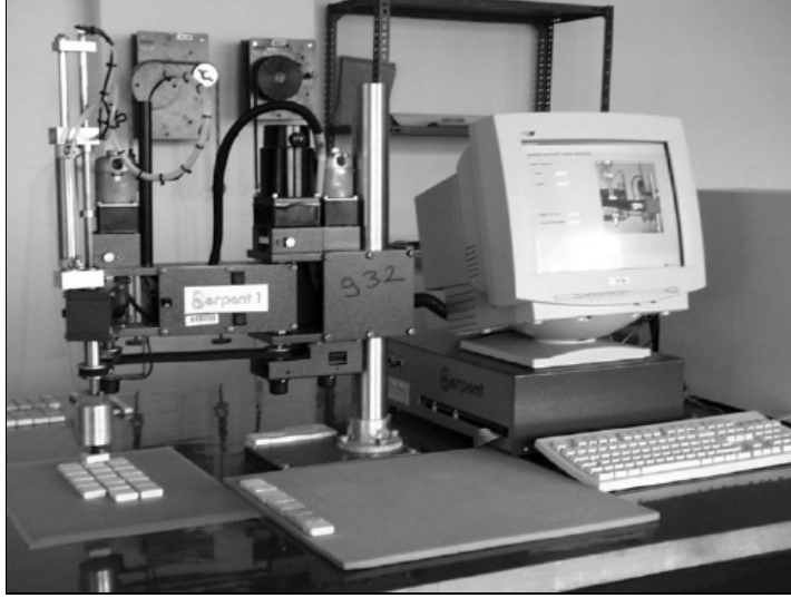
Şekil 3.2. Oral ve Erzincanlı tarafından gerçekleştirilen SCARA robot ile bilgisayar destekli mozaik dizme çalışması.
