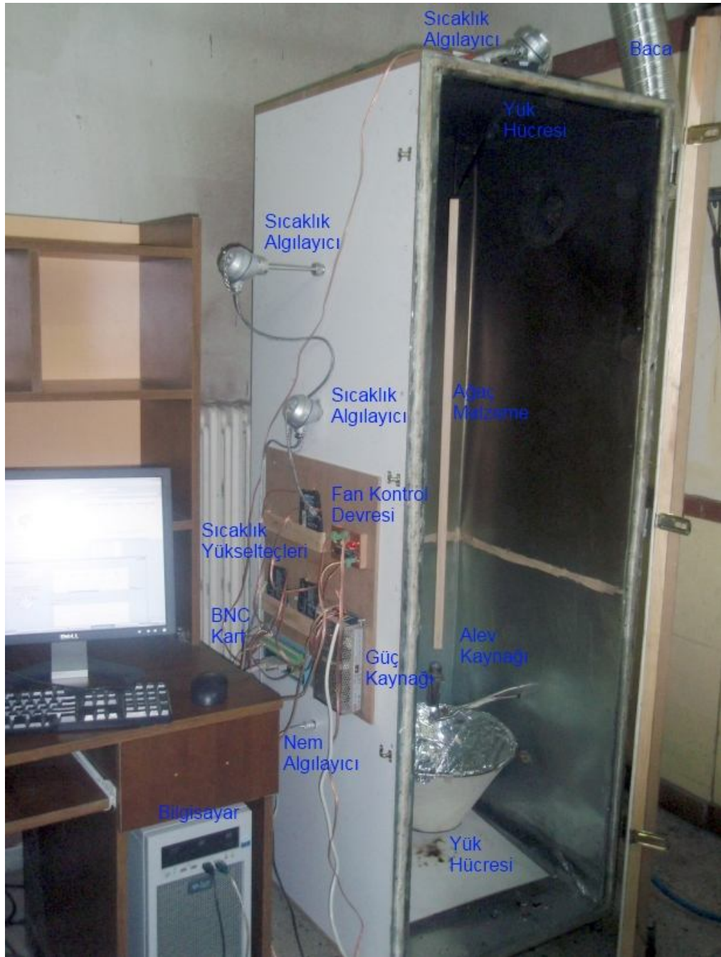
Şekil 3.2. Ağaç malzeme yanma düzeneği genel görünümü.
