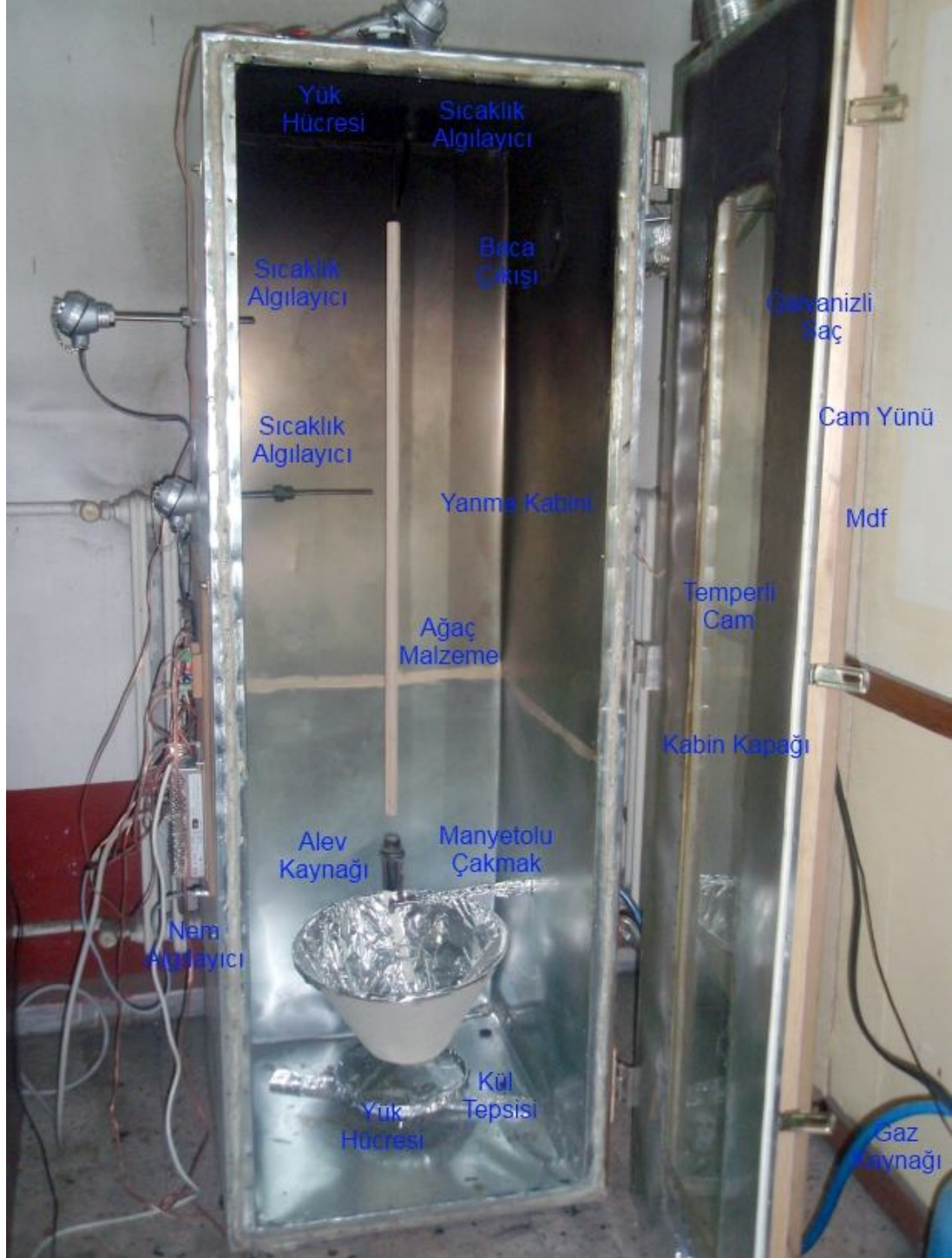
Şekil 3.9. Ağaç malzeme yanma kabini.
