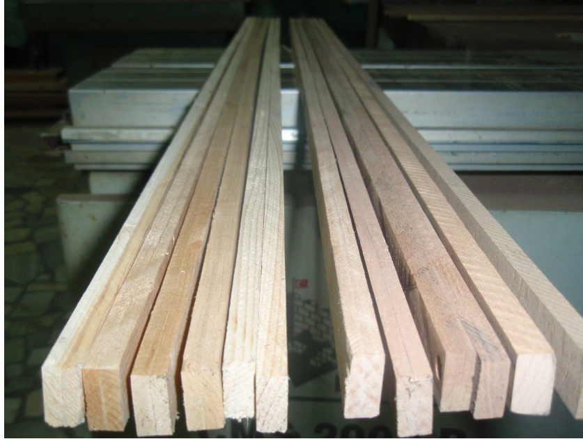
Şekil 3.10. Sarıçam ve doğu kayını deney numuneleri.
