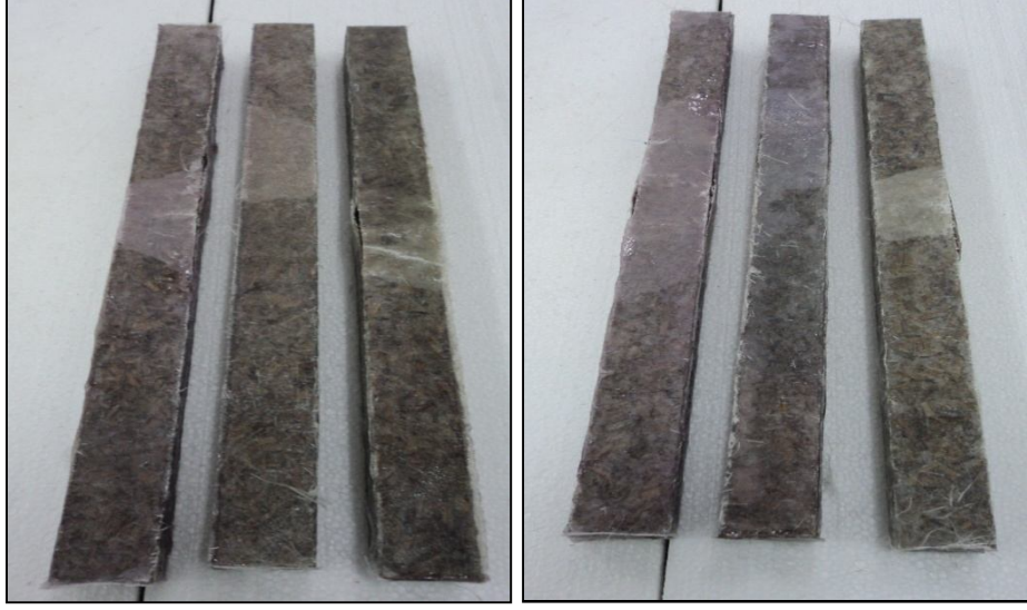
Şekil 5.11. Tek kat ve iki kat elyaf uygulamalı palmye/cam elyaf biyokompozit numunelerinin deney sonrası görünüşü.
