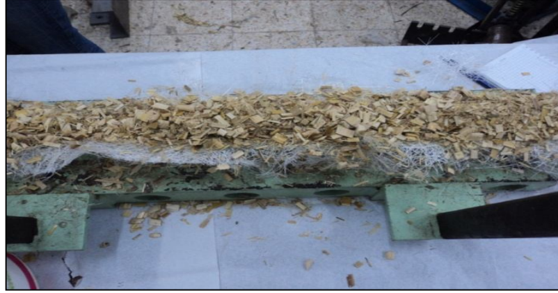
Şekil 4.13 Mısır liflerinin kalıba yerleştirilmesi.
