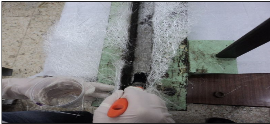
Şekil 4.10. Kalıba elyaf yatırılması.
