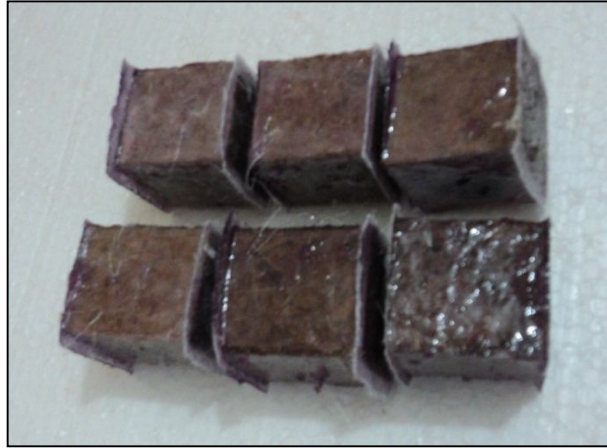
Şekil 5.32. Muz/cam elyaf biyokompozit su tutma deney numuneleri.
