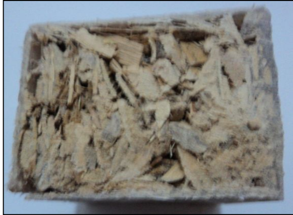
Şekil 5.41. Mısır/cam elyaf biyokompozitlerde kesme yöntemleri; (a) Yatar daire testere ile kesme, (b) Profil kesme makinesi ile kesme, (c) Kıl testere ile kesme.
