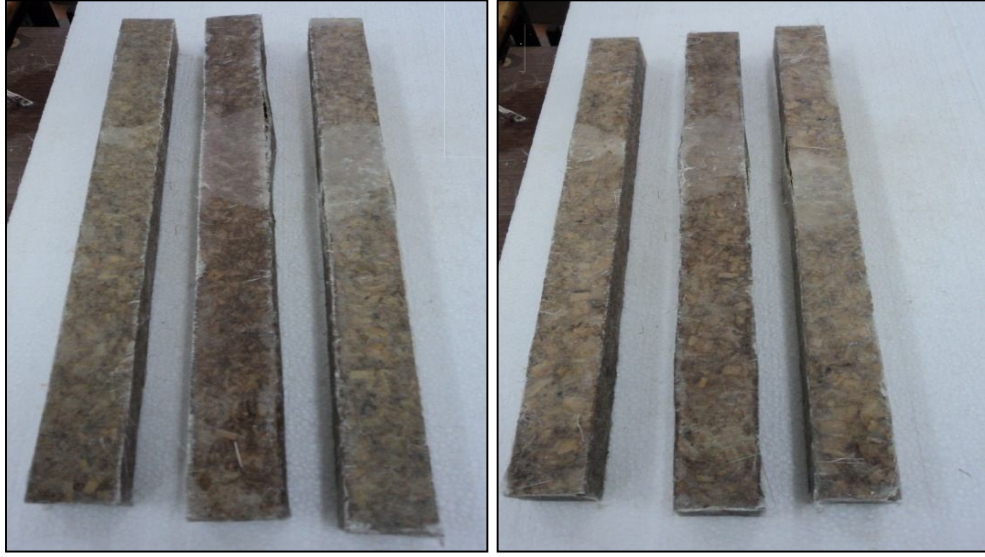
Şekil 5.8. Tek kat ve iki kat elyaf uygulamalı mısır/cam elyaf biyokompozit numunelerinin deney sonrası görünüşü.
