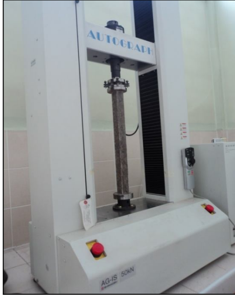
Şekil 5.12. SHIMADZU test makinesi basınç dayanımı test düzeneği.
