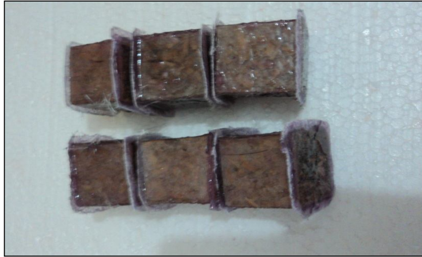
Şekil 5.33. Mısır/cam elyaf biyokompozit su tutma deney numuneleri.
