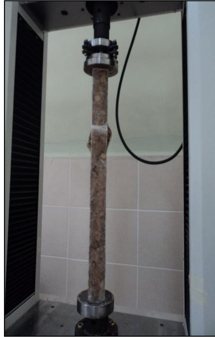
Şekil 5.17. Mısır/cam elyaf biyokompozitin P_{max} basıncı altında görünüşü.
