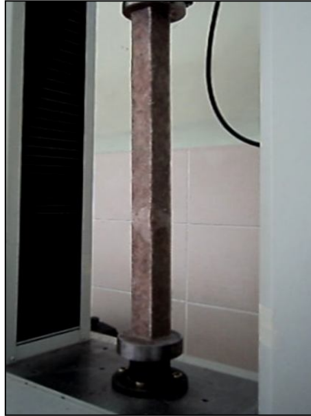
Şekil 5.14. Muz/cam elyaf biyokompozitin P_{max} basıncı altında görünüşü.
