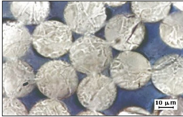
Şekil 2.9. CTP'nin mikroskopik görüntüsü [2].
