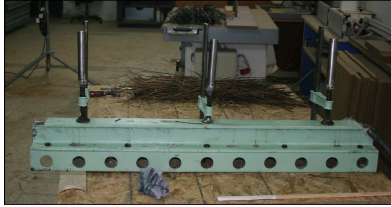
Şekil 4.9. Kalıbın kapalı haldeki resmi.
