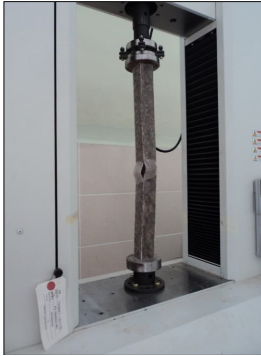
Şekil 5.20. Palmiye/cam elyaf biyokompozitin P_{max} basıncı altında görünüşü.
