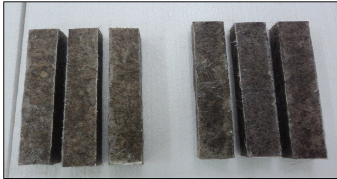
Şekil 5.23. Muz/cam elyaf biyokompozit dinamik eğilme direnç testi numuneleri.
