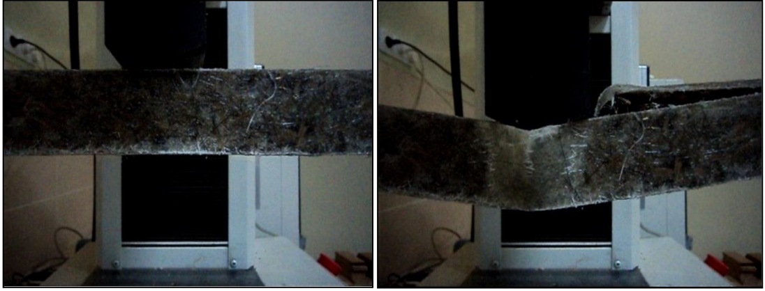
Şekil 5.10. Palmiye/cam elyaf biyokompozitlerin eğilme testi başlangıcı ve F_{max} kuvvetinin uygulandığı an.
