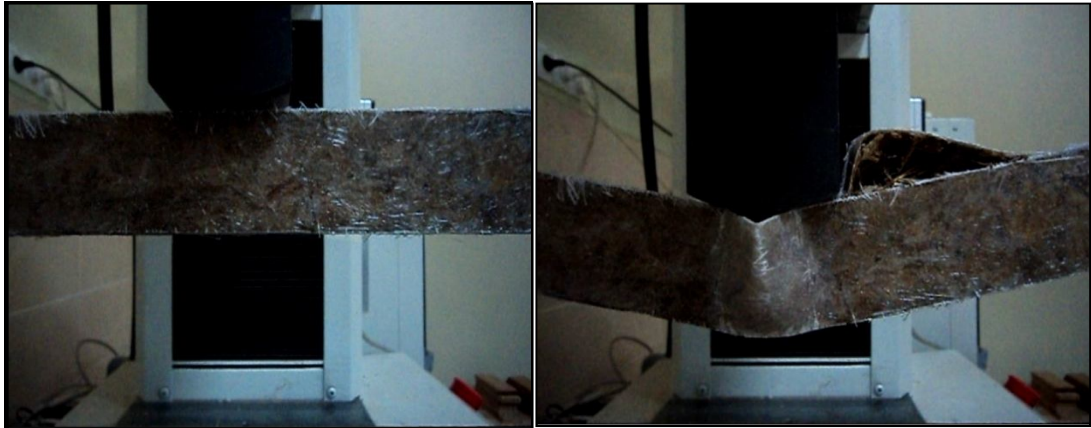
Şekil 5.4. Muz/cam elyaf biyokompozitin eğilme testi başlangıcı ve F_{max} kuvvetinin uygulanma anı.
