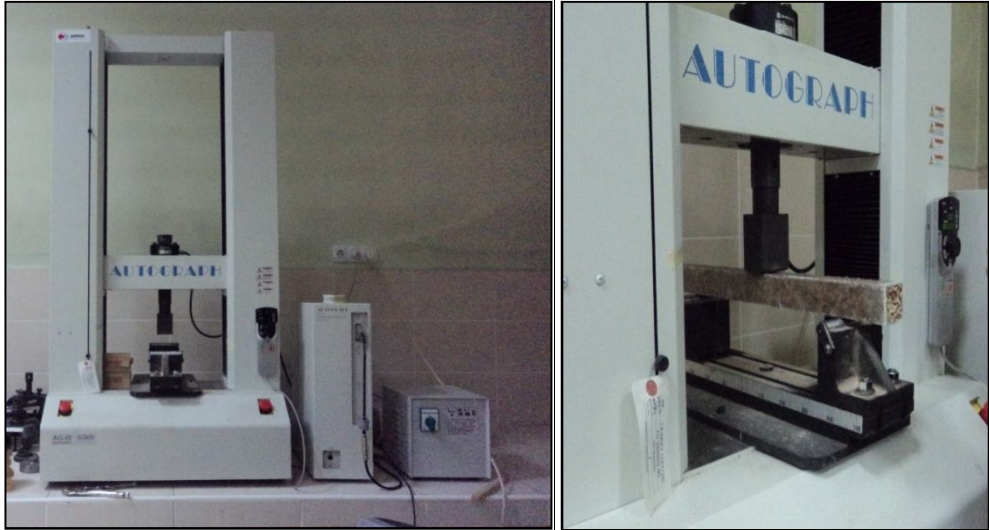
Şekil 5.1. SHIMADZU test makinesi ve eğilme test düzeneği.
