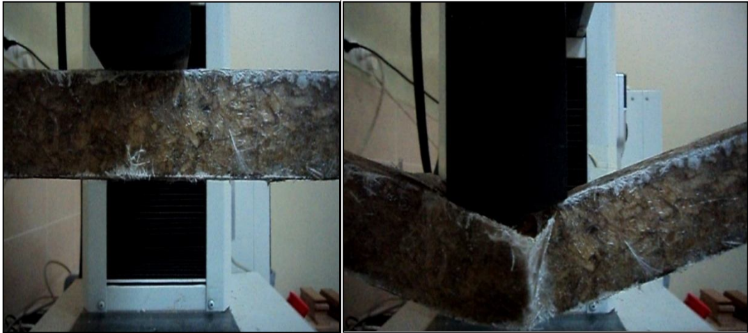
Şekil 5.7. Mısır/cam elyaf biyokompozitlerin eğilme testi başlangıcı ve F_{max} kuvvetinin uygulanma anı.
