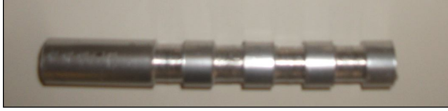
Şekil 5.6. Eksen doğruluk kontrolleri için işlenen alüminyum iş parçası.
