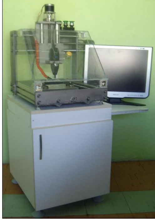
Şekil 4.1. İmalat tamamlanan masaüstü CNC freze tezgahı.
