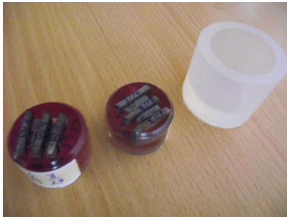
Şekil 5.4. Numuneleri şeffaf reçineye alma işlemi ve konumlandırılması
