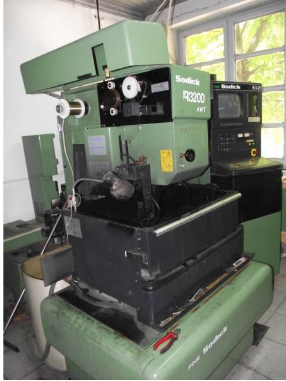
Şekil 5.6. Sodick Apt II A marka CNC tel elektro erezyon tezgahı
