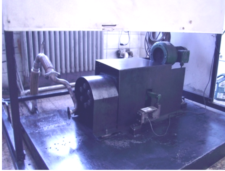
Şekil 4.3. Kullanılan elektrikli fren dinamometre görüntüsü.
