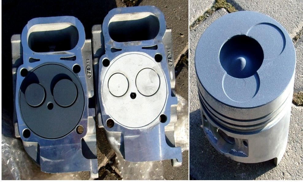
Şekil 4.8. Yanma odası elamanlarının kaplama yapıldıktan sonraki görünüşleri.
