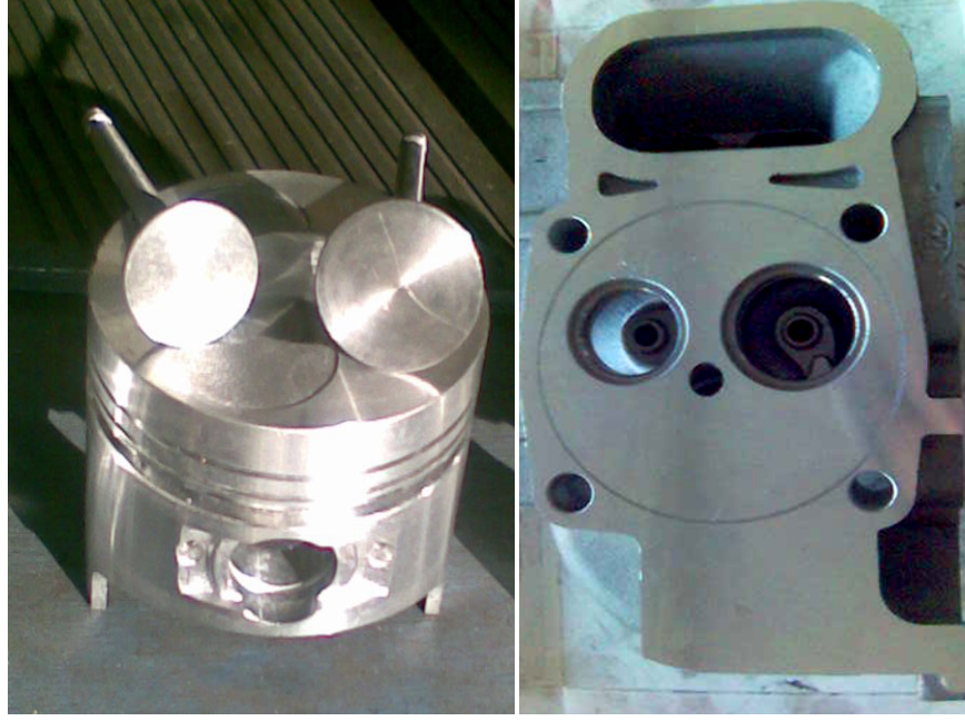
Şekil 4.7. Yanma odası elamanlarının kaplama yapılmadan önceki görüntüsü.
