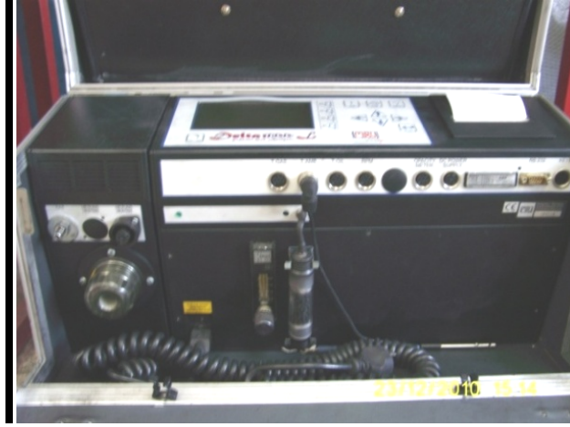
Şekil 4.6. MRU Delta 1600L egzoz gaz analizör cihazı.
