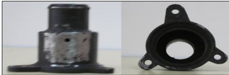
Şekil 4.8. Termostat yuvasının bağlama ve tahliye deliklerinin oluşturulmuş hali.
