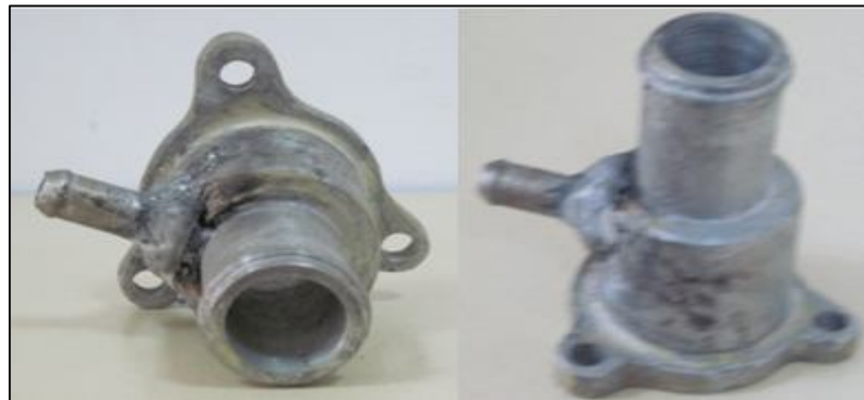
Şekil 4.6. Termostat yuvasının uç kısmına alüminyum kaynağı yapılması.
