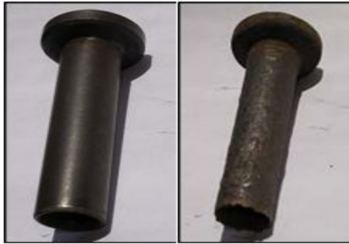
Şekil 2.1. Korozyon deneyi sonucunda supap iticilerinin görüntüsü, borlanmış çil döküm supap iticisi, borlanmamış çil döküm supap iticisi.
