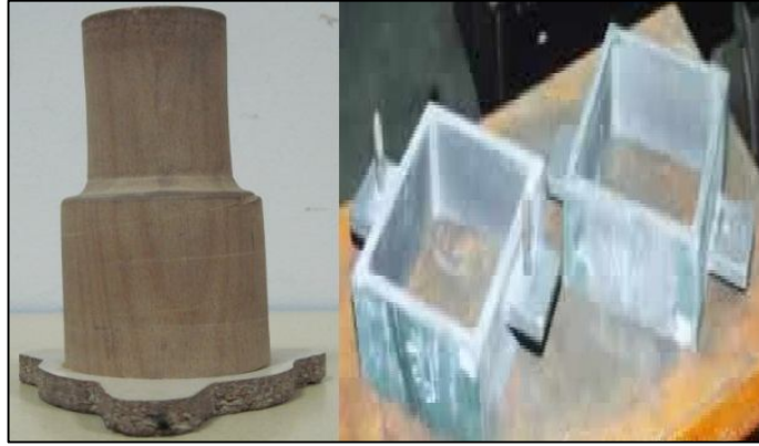
Şekil 4.2. Parçanın modeli ve derece.
