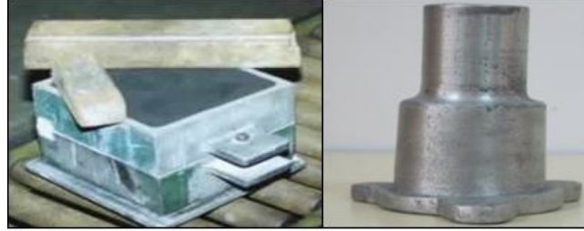
Şekil 4.4. Kalıbın üzerine ağırlık konması ve dökümden çıkan parça.
