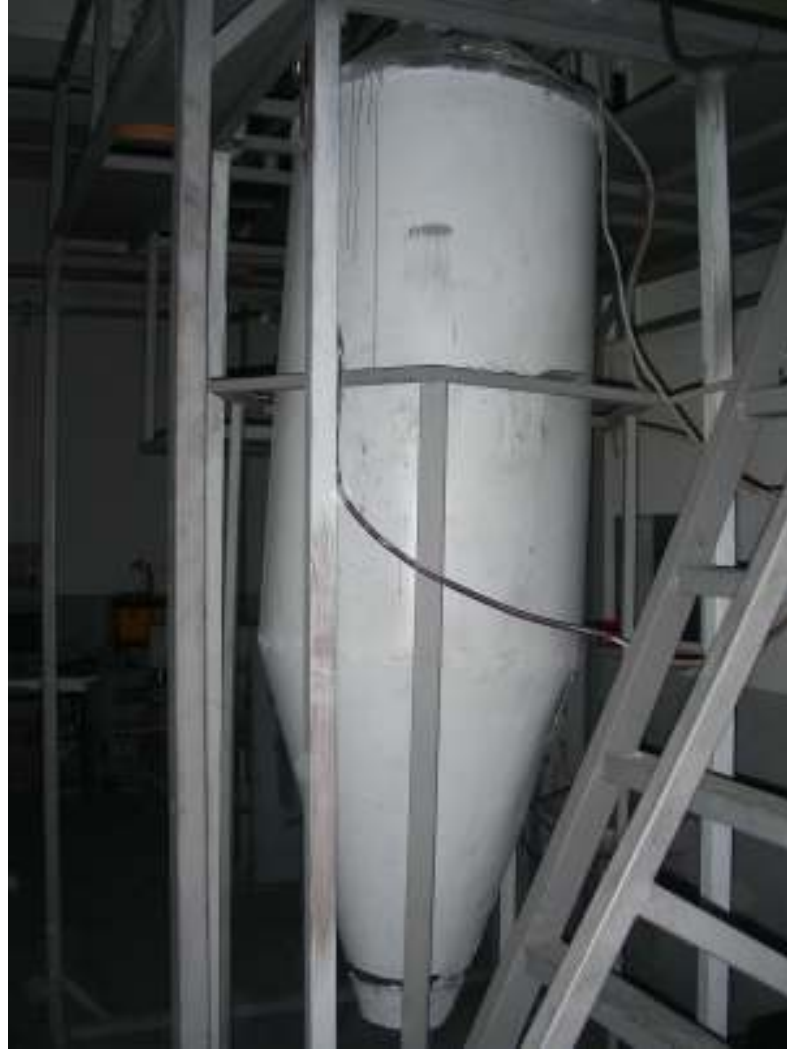
Şekil 4.9. Paslanmaz çelikten imal edilen atomizasyon kulesi.
