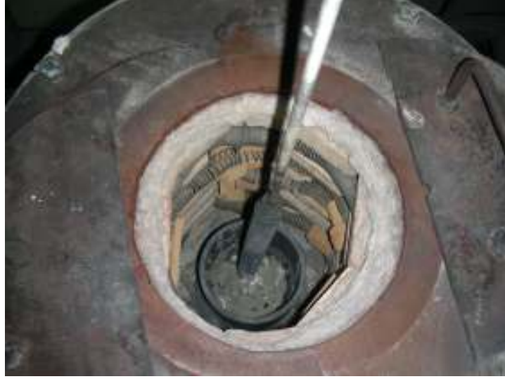
Şekil 4.4. Metal ergitme fırını, grafit pota ve açma kapama çubuğu.
