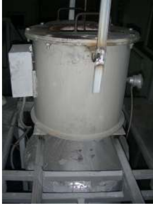
Şekil 4.5. Raylar üzerinde hareket edebilen ergitme fırını
