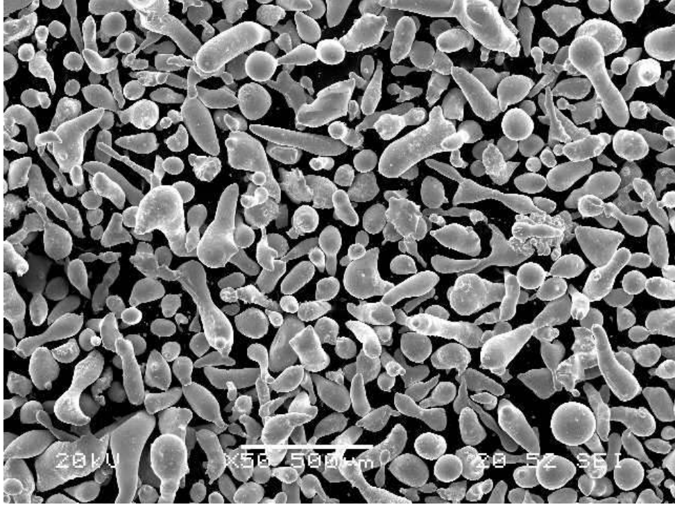
Şekil 5.2. 4 mm nozul çapı ve 4 bar gaz basıncında üretilen tozların SEM görüntüsü.
