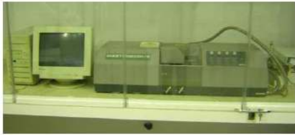
Şekil 4.11. Malvern Mastersizer E partikül boyutu ölçme cihazı.
