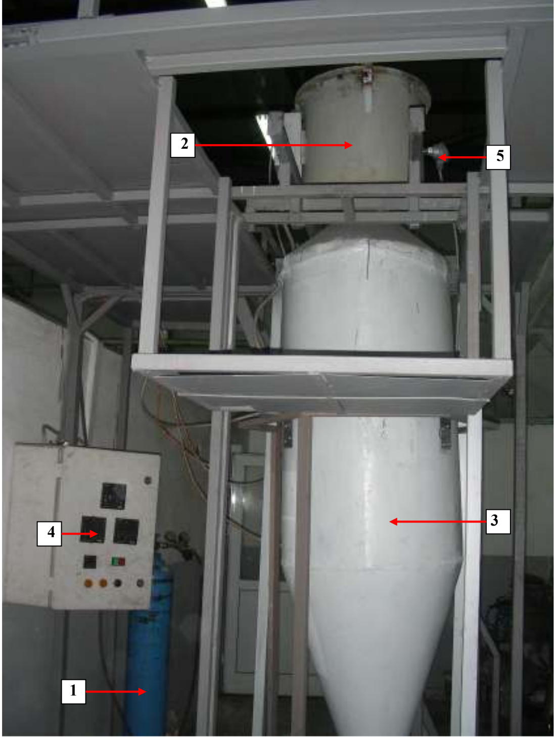
Şekil 4.1. Karabük Üniversitesi gaz atomizasyon ünitesi (1-Gaz sistemi, 2-Ergitme fırını, 3-Atomizasyon kulesi, 4-Kontrol panosu, 5- Termokupl).
