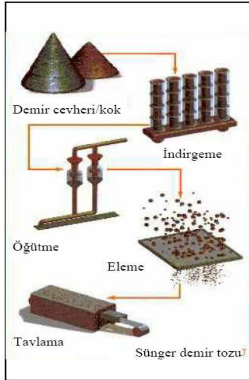
Şekil 2.6. Kimyasal yöntemle demir tozu üretimi [14].
