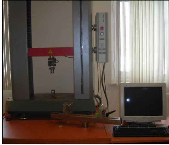
Őekil 5.3. Kesme testinin yapıldığı cihaz fotoęrafı
