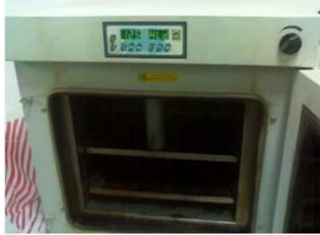
Şekil 5.1. 180°C de Yaşlandırma ısıtılabilen malzemenin yapıldığı fırın.
