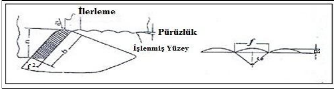
Şekil 4.1. İlerleme hızı ve takım uç yarıçapının yüzey pürüzlülüğüne etkisi (Gadalmaz ve Koura, 2002).
