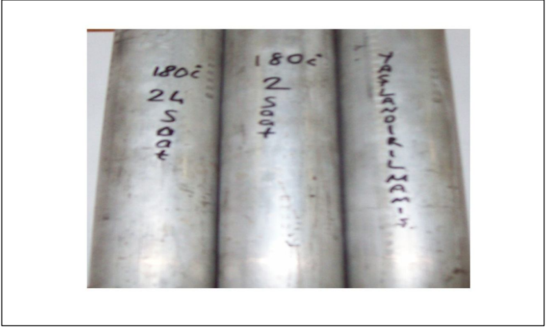
Şekil 5.5. Deneyler için hazırlanan AA 6082 yaşlandırılmış ve yaşlandırılmamış numuneler
